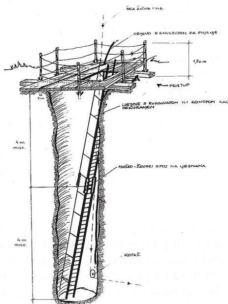
Sl. 14. Shematski prikaz bunara za uvođenje vodilice i rad helikoidalne žice
