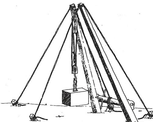
Sl. 8. Jednostavna naprava dizalica za dizanje kamenih blokova s vitlom na ručni pogon
