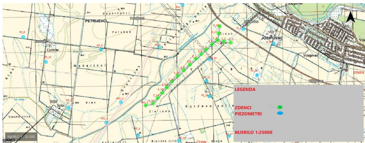
Slika 2-1. Položaj eksploracijskih zdenaca i piezometara na vodocrpilištu Vinogradi (TK25)
