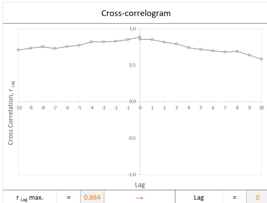
**Slika 5-29. Prikaz kros-koreograma crpljenje/RPV za piezometar PZ\_4\_1**
