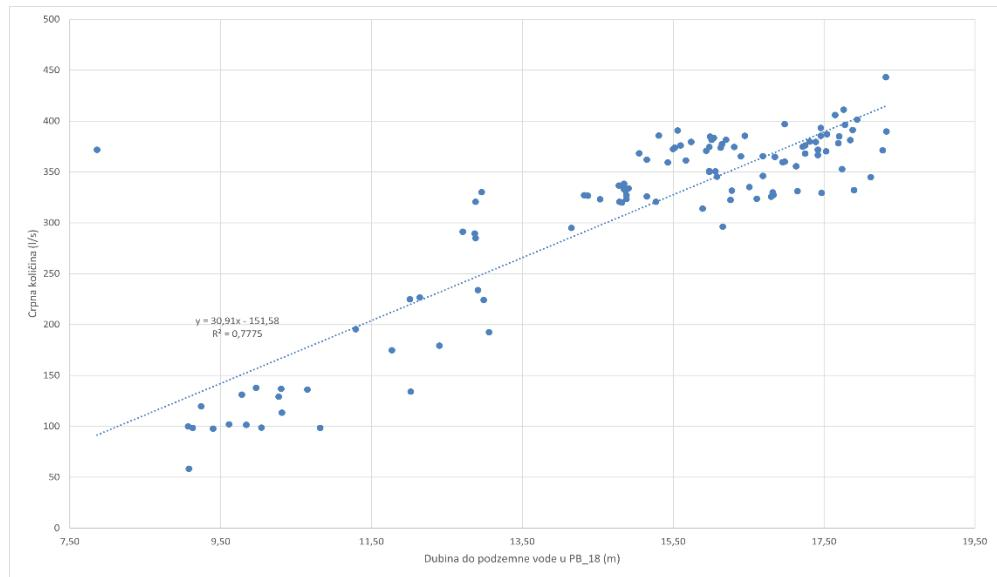
Slika 5-44. Prikaz regresijskog modela za crpljenje/dubine do p.v. za piezometar PB\_18
