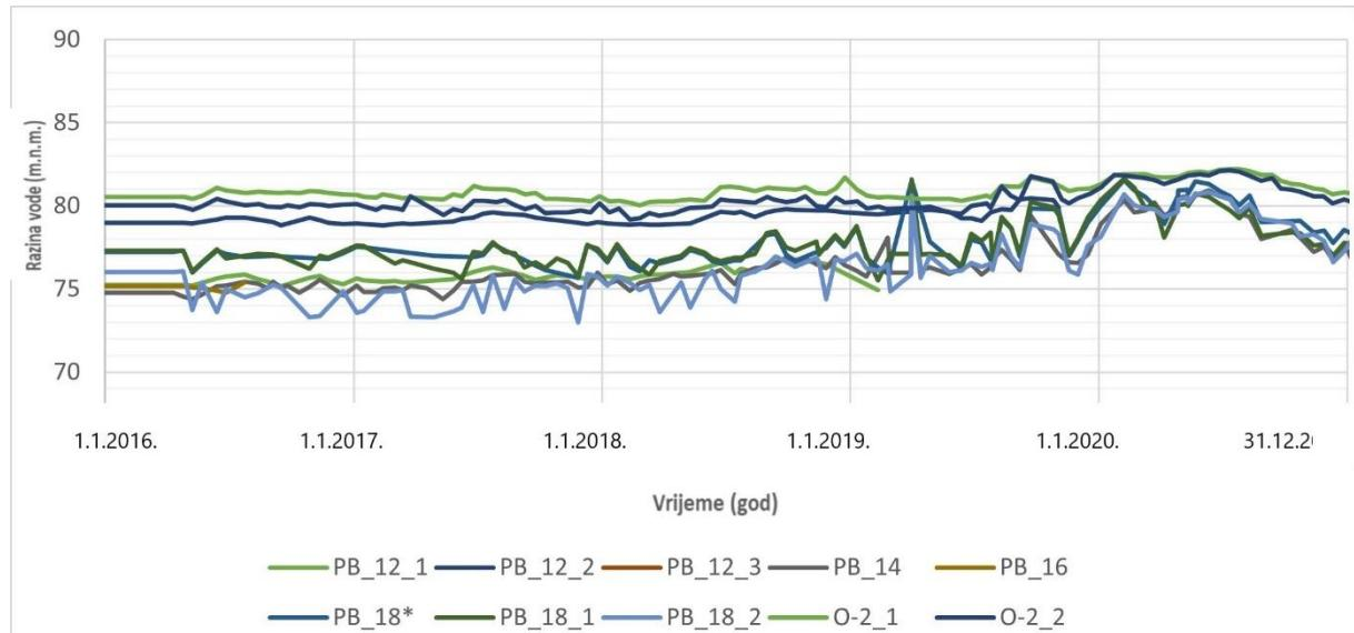
**Slika 5-6. Nivogrami piezometara udaljenih 100-500 m od zdenaca**
