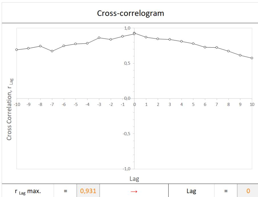
Slika 5-32. Prikaz kros-korelograma crpljenje/RPV za piezometar PZ\_4\_4
