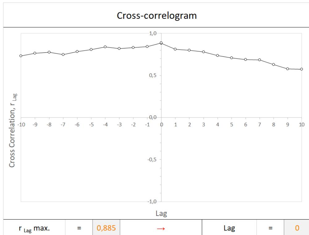
Slika 5-36. Prikaz kros-korelograma crpljenje/RPV za piezometar PB\_18
