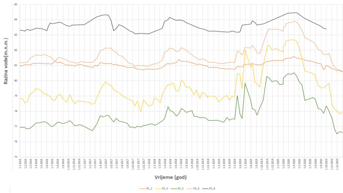
**Slika 5-3. Nivogrami (kolebanje razina podzemne vode) udaljenijih piezometara**
