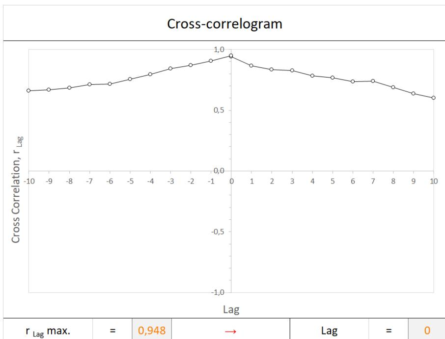
Slika 5-33. Prikaz kros-korelograma crpljenje/RPV za piezometar PZ\_5
