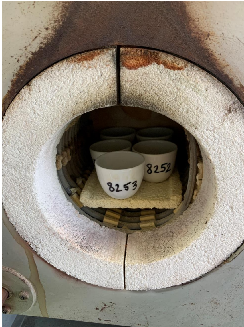
Slika 6.4. Žarenje uzoraka na 350 °C i 550 °C
