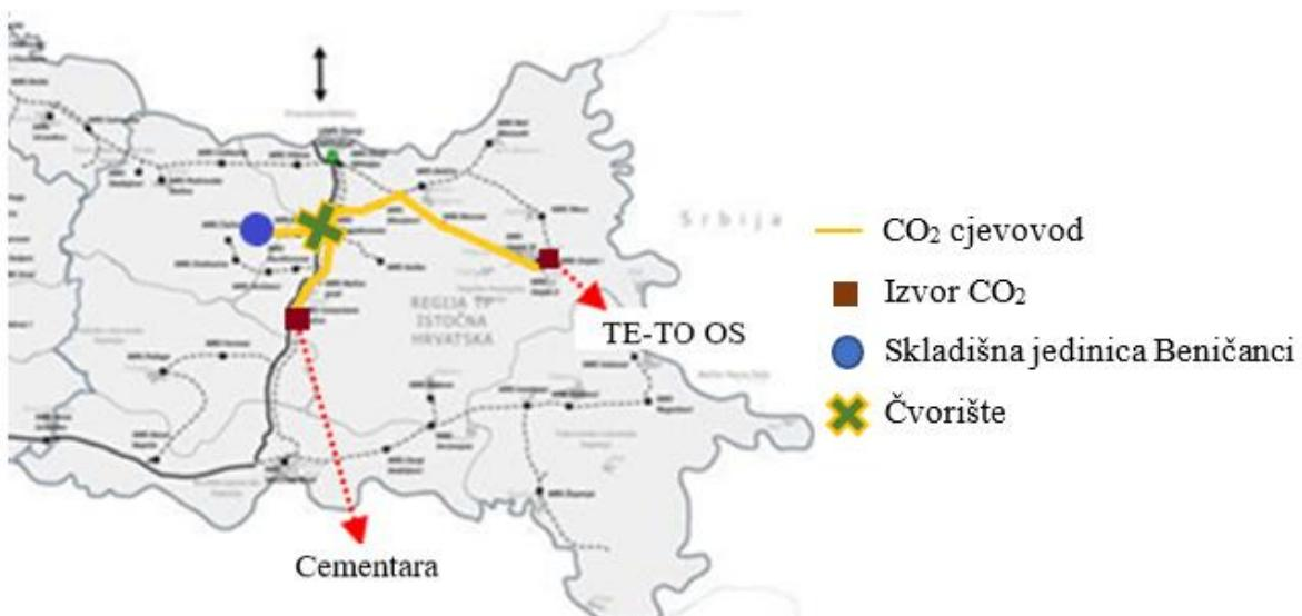
**Slika 7-3.** Konfiguracija mreže cjevovoda za transport CO<sub>2</sub> u istočnoj regiji (prema [www.plinacro.hr](http://www.plinacro.hr), 2021a)
