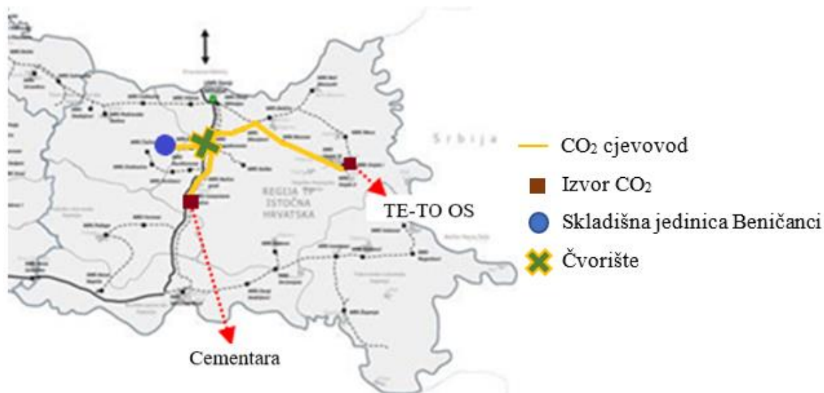
Slika 7-3. Konfiguracija mreže cjevovoda za transport CO 2 u istočnoj regiji (prema www.plinacro.hr , 2021a)
