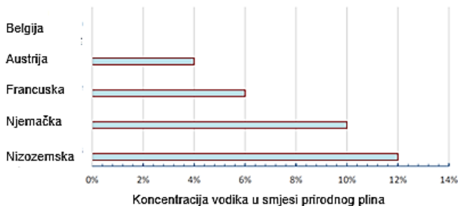
Slika 5-1. Dozvoljena koncentracija vodika u transportnom sustavu prirodnog plina (Krsnik i Pavlović, 2020)
