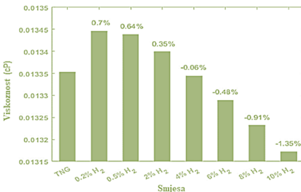
Slika 3-6. Utjecaj koncentracije vodika na viskoznost smjese prirodnog plina (Ali Abd et al., 2021)
