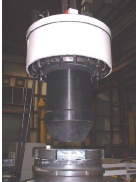
Slika 8-3. Prikaz hidraulične alatke za rukovanje usponskim cijevima na podištu tornja (Aker Solutions, 2010)
