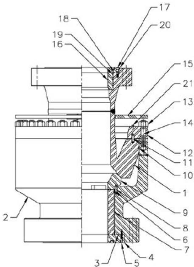
**Slika 2-2.** Prikaz unutarnjih dijelova podvodne kuglaste spojnica (Oil States Industries, 2015a)
