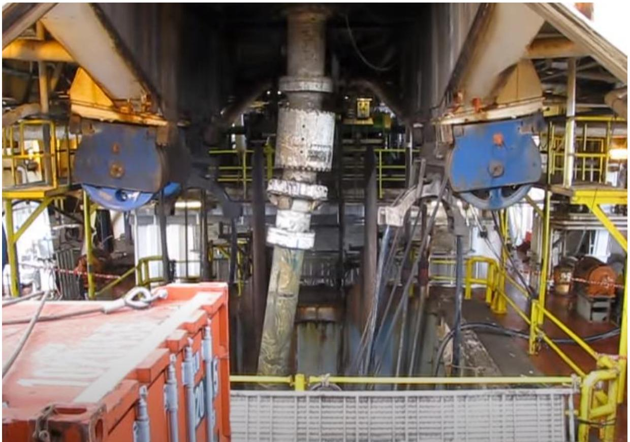
**Slika 2-3.** Gornja kuglasta spojnica (engl. *diverter flexible joint*) na bušačem brodu (<https://www.youtube.com>, 2009)
