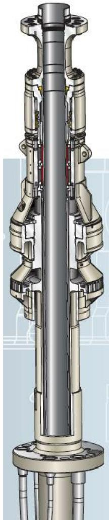
**Slika 5-1.** Shematski prikaz teleskopske spojnica (Drill-Quip, 2014)
