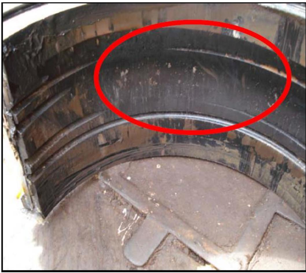
**Slika 5-4.** Nejednoliko potrošen brtveni element teleskopske spojnice (Upton, 2009)
