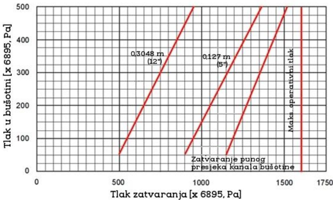
**Slika 7-5.** Prikaz potrebnog tlaka zatvaranja divertera u ovisnosti o bušačem alatu i tlaku u bušotini (Hydril, 2001)
