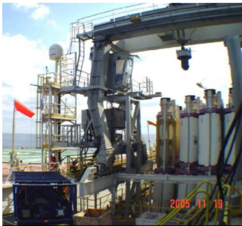
**Slika 8-4.** Smještaj hidraulične alatke za rukovanje iznad uspravljenog postavljenih usponskih cijevi (Aker Solutions, 2010)
