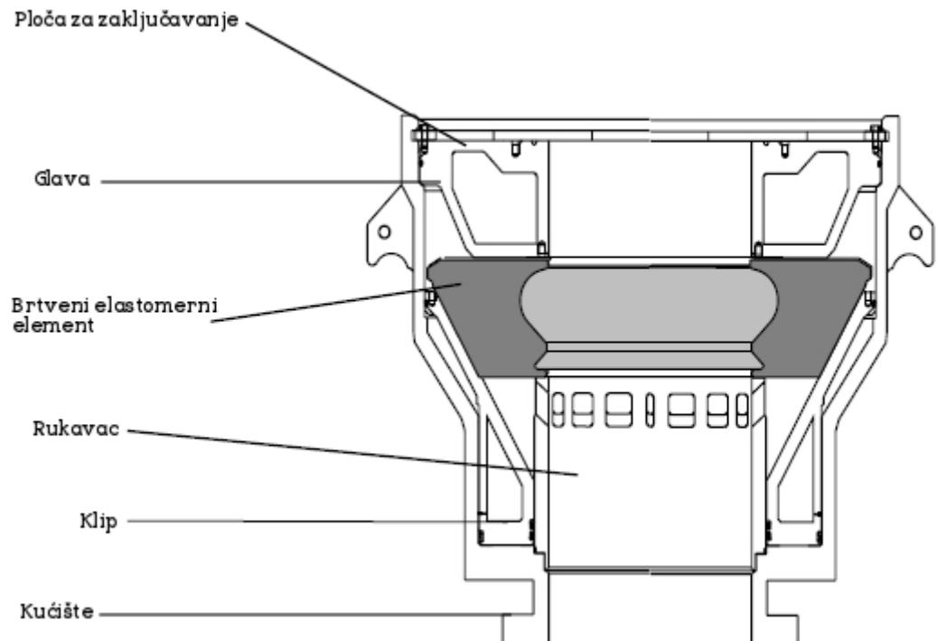
**Slika 7-3.** Prikaz osnovnih dijelova divertera (Hydril, 2001)
