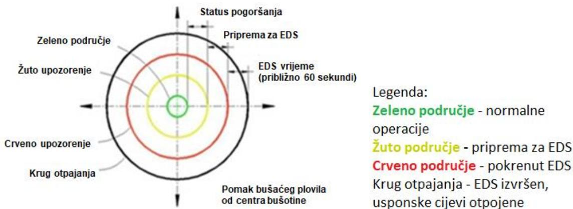
**Slika 4-1.** Shematski prikaz graničnih područja u kojima se obavljaju unaprijed određene radnje (Krištafor, 2021)
