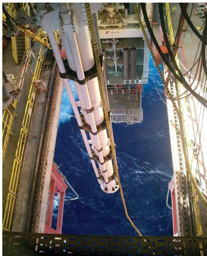
Slika 3-1. Prikaz usponskih cijevi i pridruženih vodova (Krištafor, 2021)
