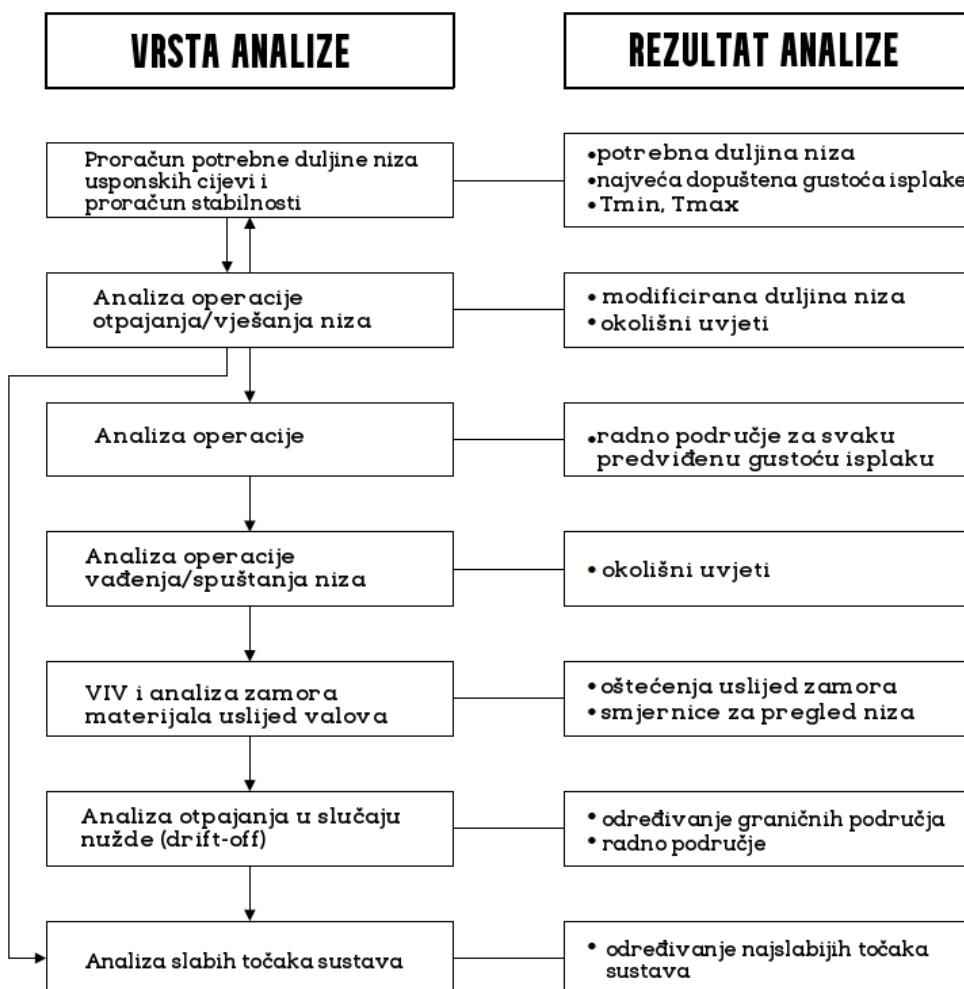
Slika 3-2. Hodogram za odabir sustava usponskih cijevi (ABS, 2017)
