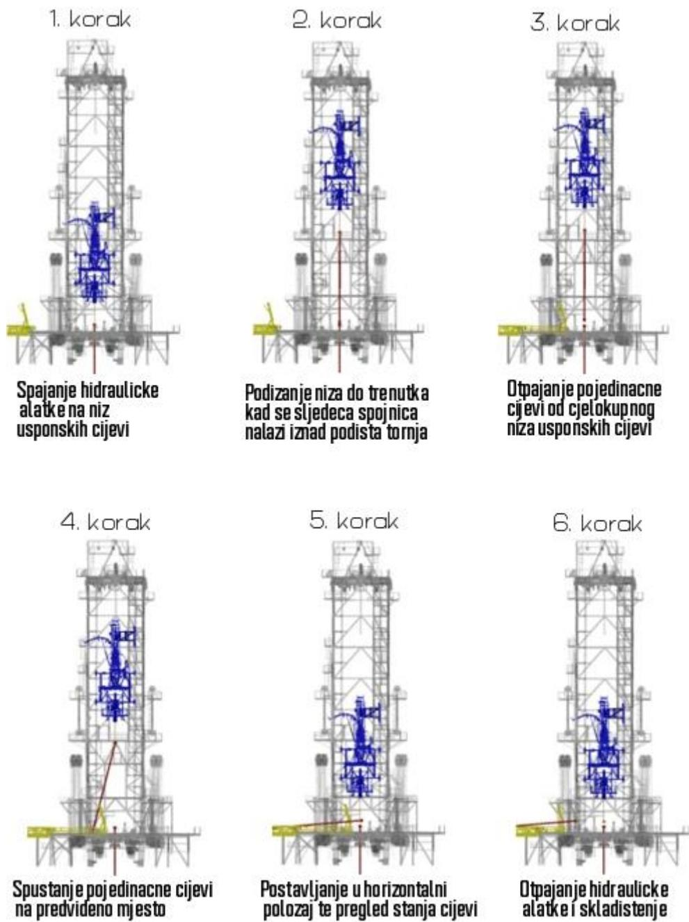
**Slika 8-5.** Shematski prikaz izvlačenja pojedinačnih elemenata niza usposnih cijevi po koracima (Roe Flobakk, 2012)
