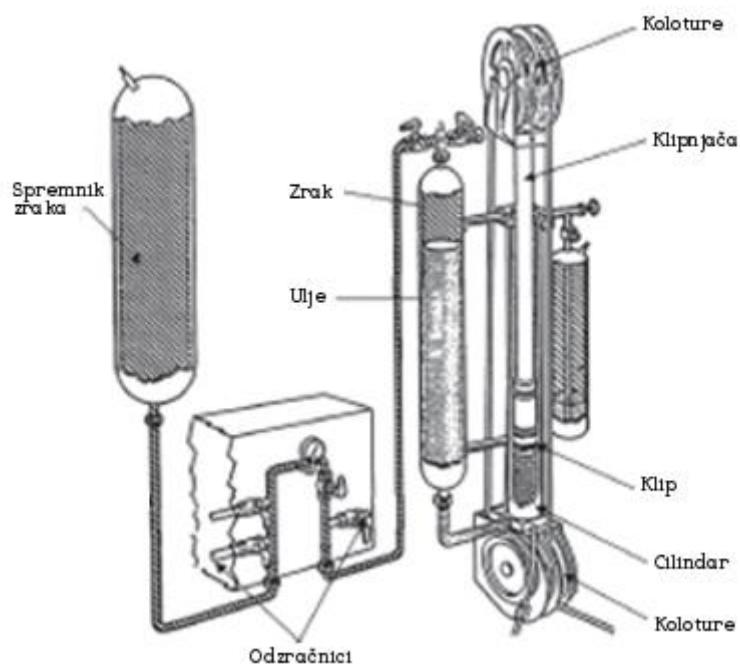
**Slika 6-1.** Prikaz komponenata nateznog sustava usporskih cijevi (Laik, 2018)
