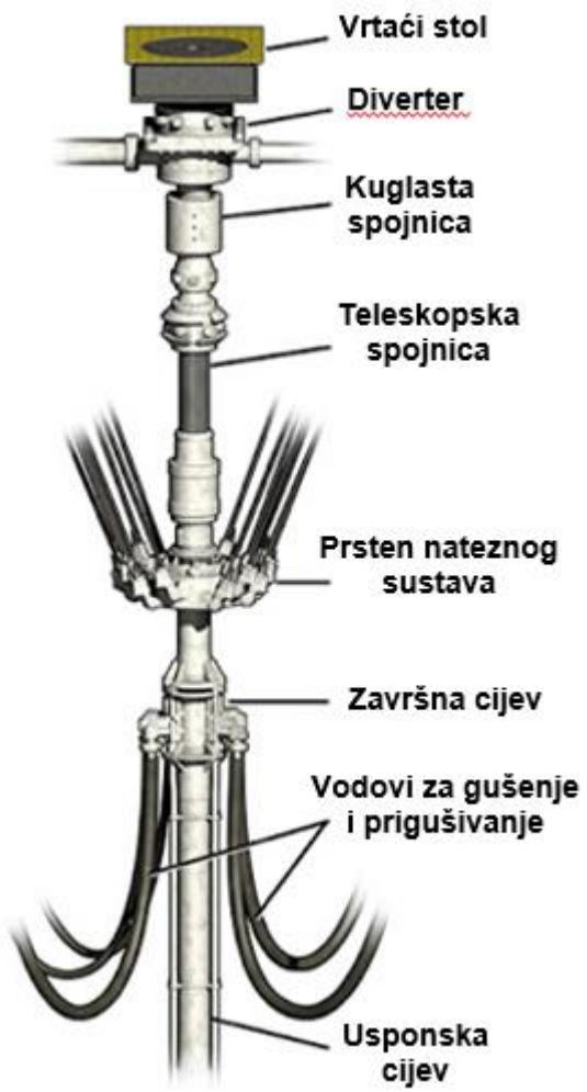
**Slika 7-2.** Prikaz položaja divertera kod sustava s nizom uspontskih cijevi (Krištafor, 2021)
