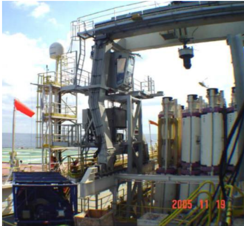
Slika 8-3. Prikaz hidraulične alatke za rukovanje usponskim cijevima na podištu tornja (Aker Solutions, 2010)
