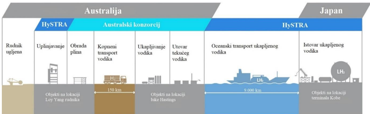
Slika 4-5. Shema HESC projekta (Kawasaki Heavy Industries, Ltd, 2019)
