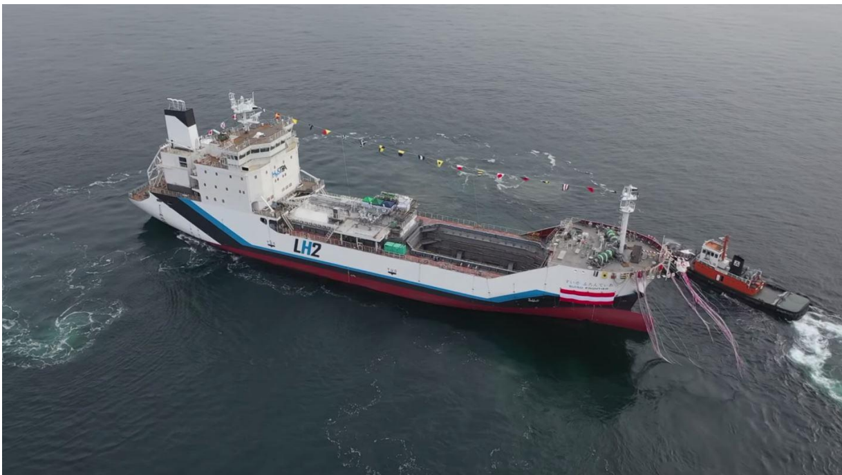
Slika 4-3. „Suiso Feontier“, brod za transport tekućeg vodika (Kawasaki Heavy Industries, Ltd, 2019)
