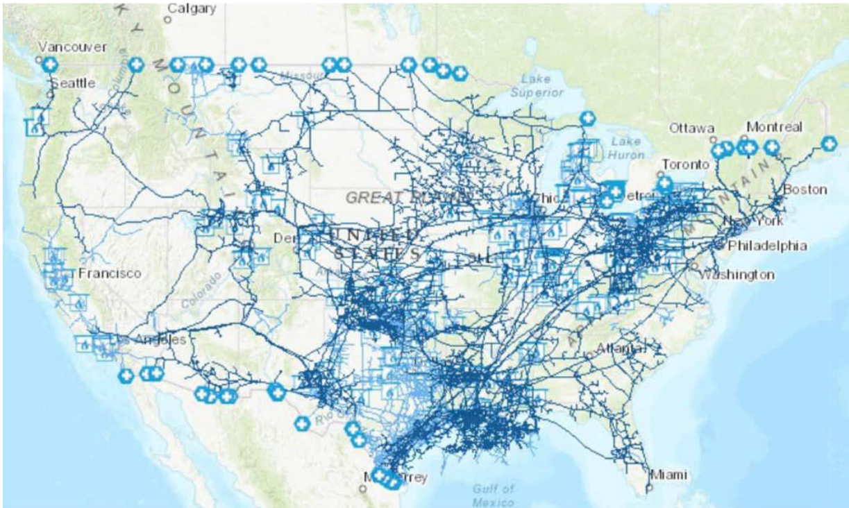
Slika 5-1. Mreža plinovoda u SAD-u s prikazanim interkonekcijama s Kanadom i Meksikom te podzemnim skladištima plina (Ehlig-Economides i Hatzignatiou, 2021)
