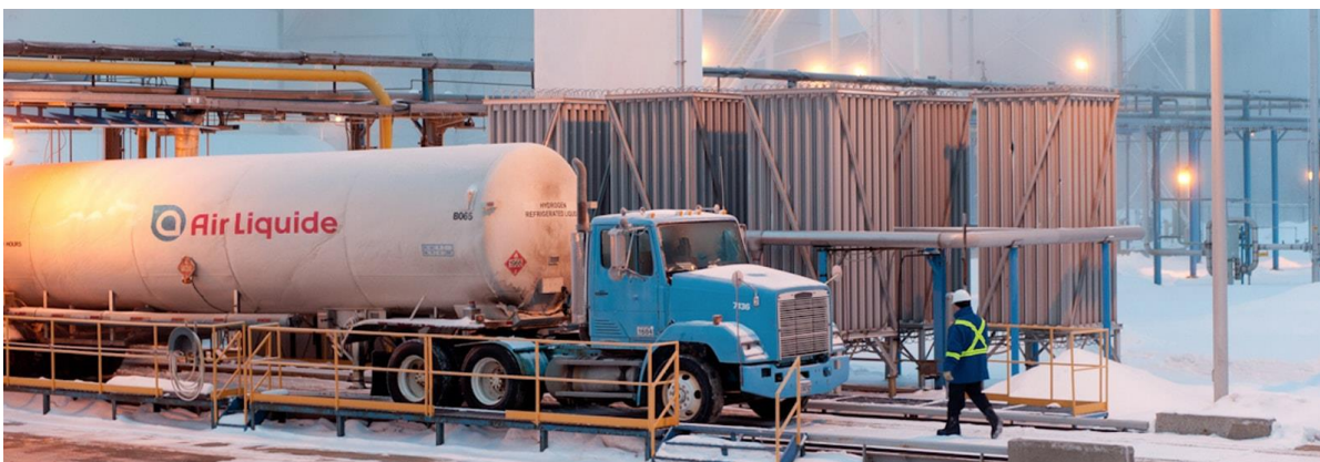
Slika 4-2. Kamion za transport tekućeg vodika (Air Liquide, 2021)
