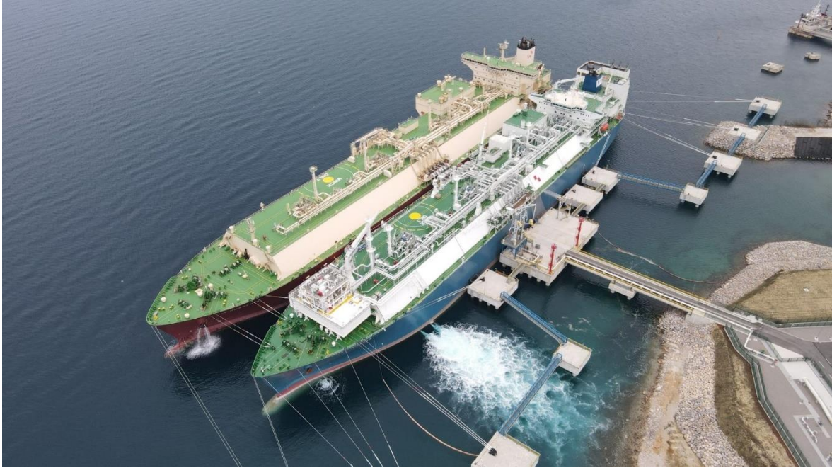
Slika 6-2. FSRU brod s jednim vezom (Novi List, 2022)
