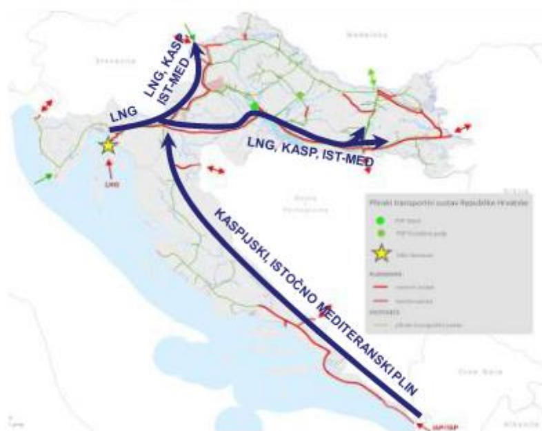
Slika 7-1. Plinovodi za nove dobavne pravce (Plinacro, 2021)
