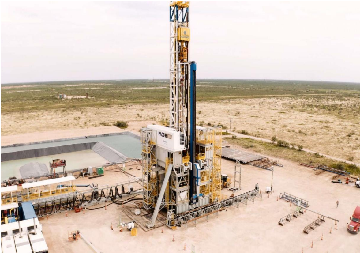
Slika 5-6. Robotizirano bušaće postrojenje PACE R801 kompanije Nabors Industries (MRT, 2021)
