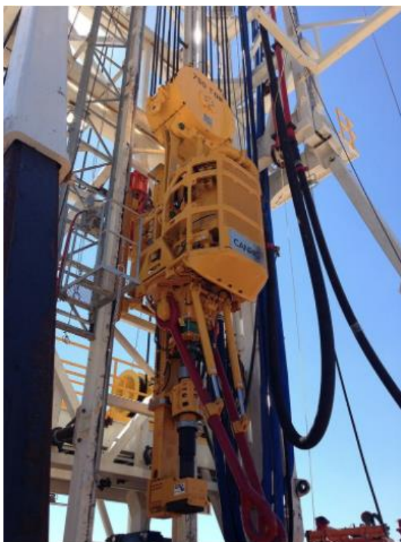
Slika 3-9. Vršni pogon Canrig® 1275 AC (klondike.no, 2021)
