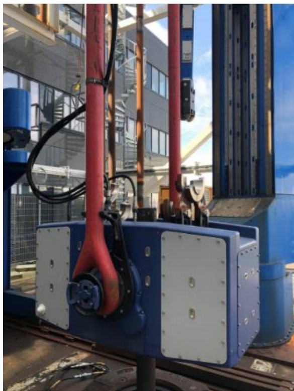
Slika 5-4. Robotizirani elevator s varijabilnim insertima za prihvat alutki različitog promjera MSE-500 (Nabors, 2021d)
