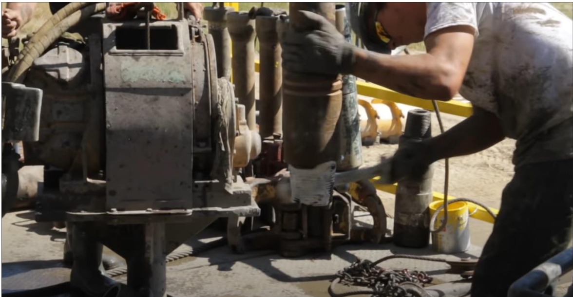
Slika 3-4. Podmazivanje muškog navoja bušaće šipke upravo uvedene u toranj pomoću zračnog vitla prije njezinog odlaganja u mišju rupu (CalculatedRiskFilms, 2014)
