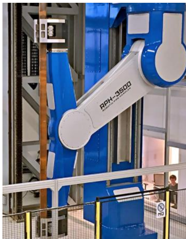
Slika 5-5. Električni robotizirani sustav za rukovanje alatkama iz horizontalnog u vertikalni položaj s 9 stupnjeva slobode gibanja RPH-3500 (Nabors, 2021e)
