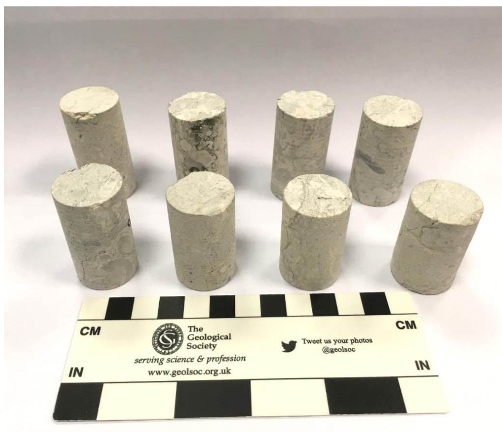
Slika 9-5 Odabrani uzorci Grubišnog Polja korišteni u laboratorijskim ispitivanjima
