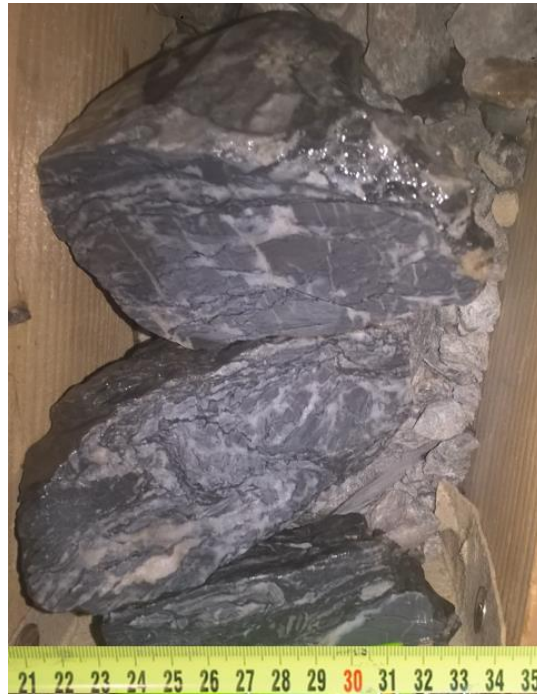
Slika 5.59: Or-2 ostatak fragmenata laminarnog i mjestimično nodularnog dolomikrita sa šejlom iz J-11
