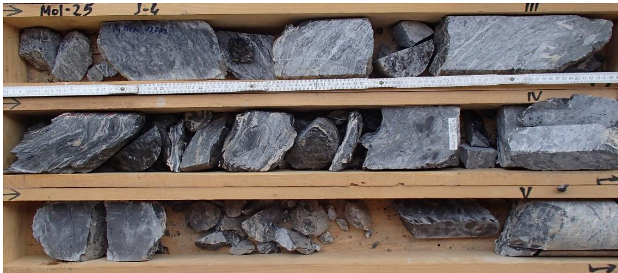
Slika 5.10: Mol-25 J-4 3., 4. i 5. m, laminirani dolomit i anhidrit
