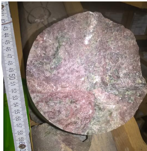
Slika 5.14: Lšn-1, hematitizirani tuf, fragment iz J-14
