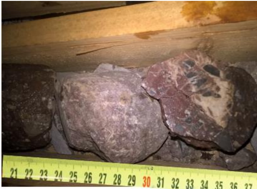
Slika 5.38: Kal-1S, hematitizirani polimiktни konglomerat, fragment iz J-5
