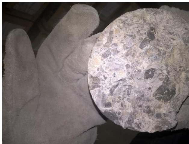
Slika 5.15: Lšn-1 J-11 fragment polimiktnog konglomerata iz 3.m jezgre
