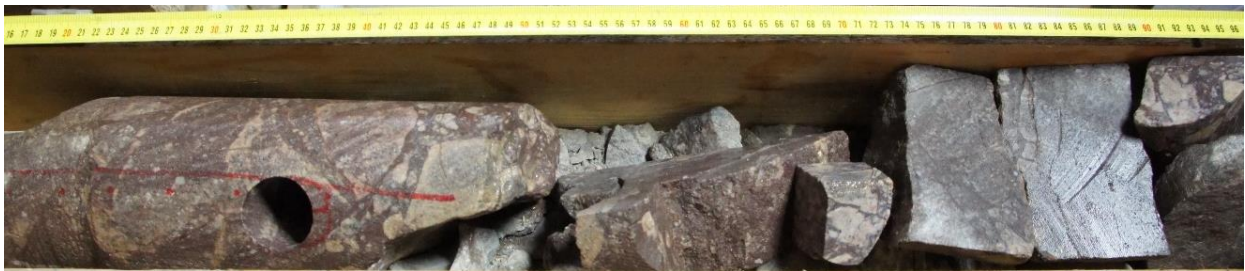
Slika 5.53: Mlj-1, matriksom potporna breča iz J-9
