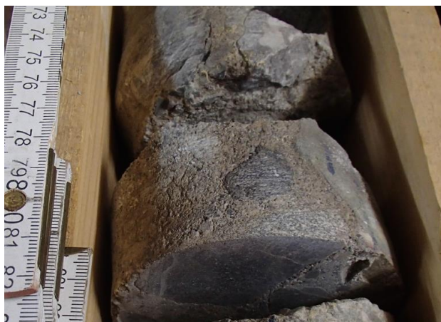
Slika 5.43: Kal-7 J-2, fragmenti polimiktnog konglomerata iz 1.m jezgre
