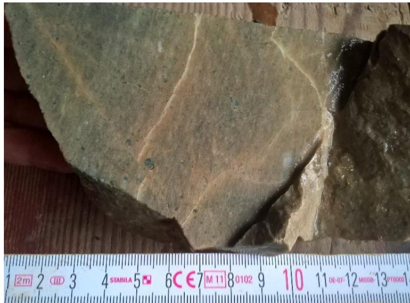
Slika 5.31: Kal-5 Al J-2, fragment tufa iz 2.m
