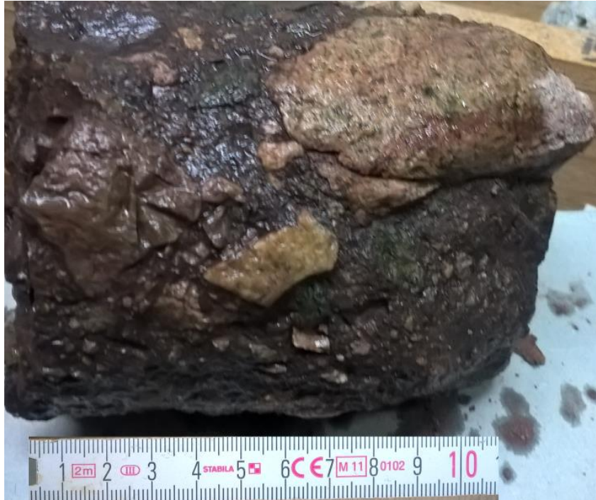
Slika 5.81: Ran-1, matriksom potporna polimiktna breča, fragment iz J-2
