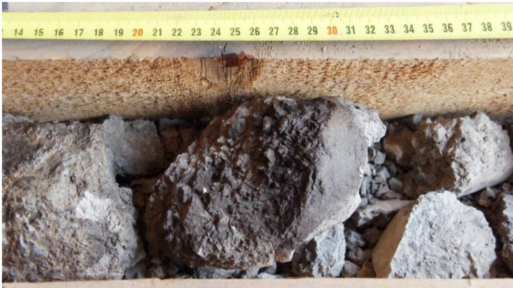
Slika 5.27: Kal-2 J-2, ostatak fragmenata klastima potporne breče iz 2.m jezgre
