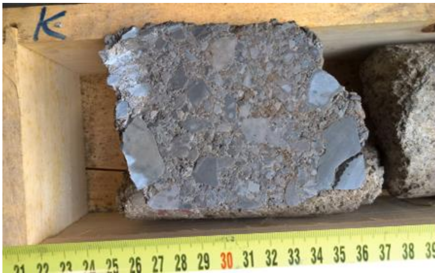
Slika 5.13: Lšn-2, fragment polimiktnog konglomerata iz 1.m J-4
