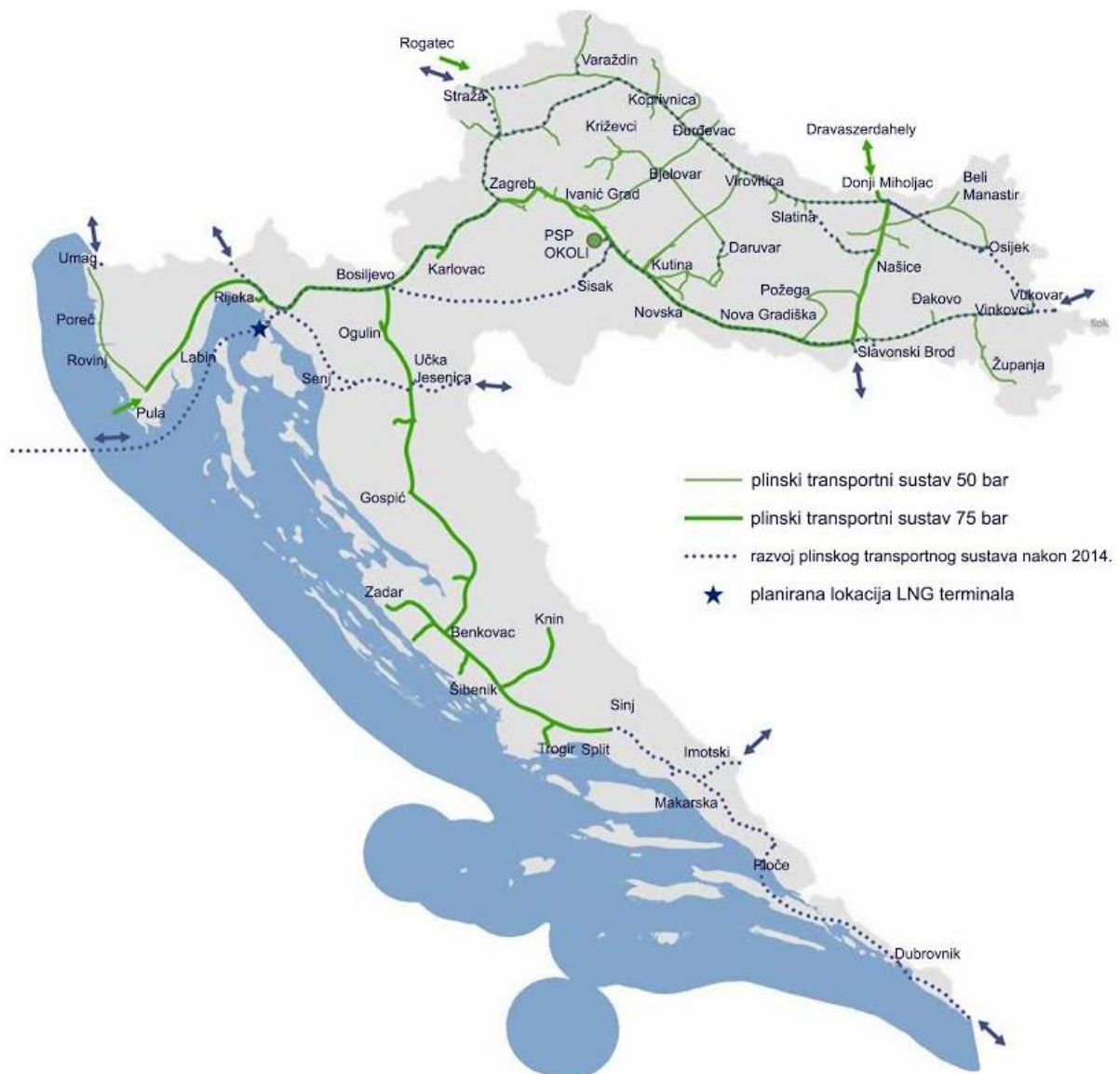
Slika 2-1. Plinski transportni sustav u Republici Hrvatskoj („Desetogodišnji plan razvoja plinskog transportnog sustava“, 2015.)
