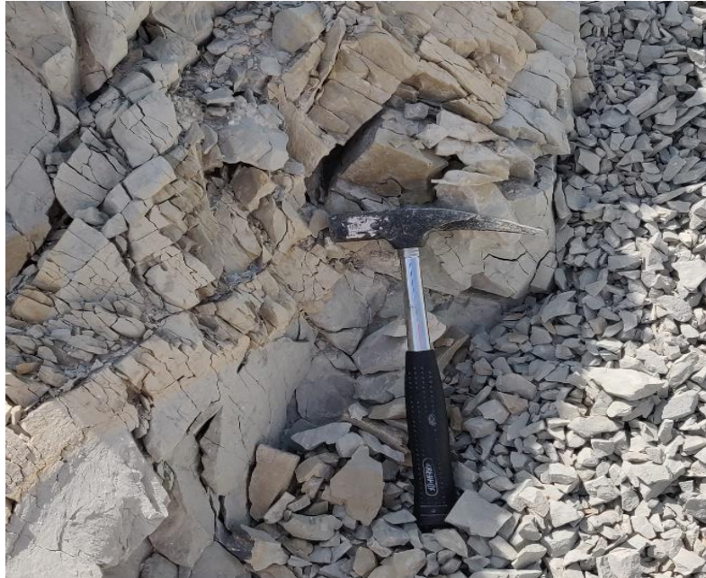
Slika 5-17. Homogeni izgled kalcitičnog lapora – „tupine“
