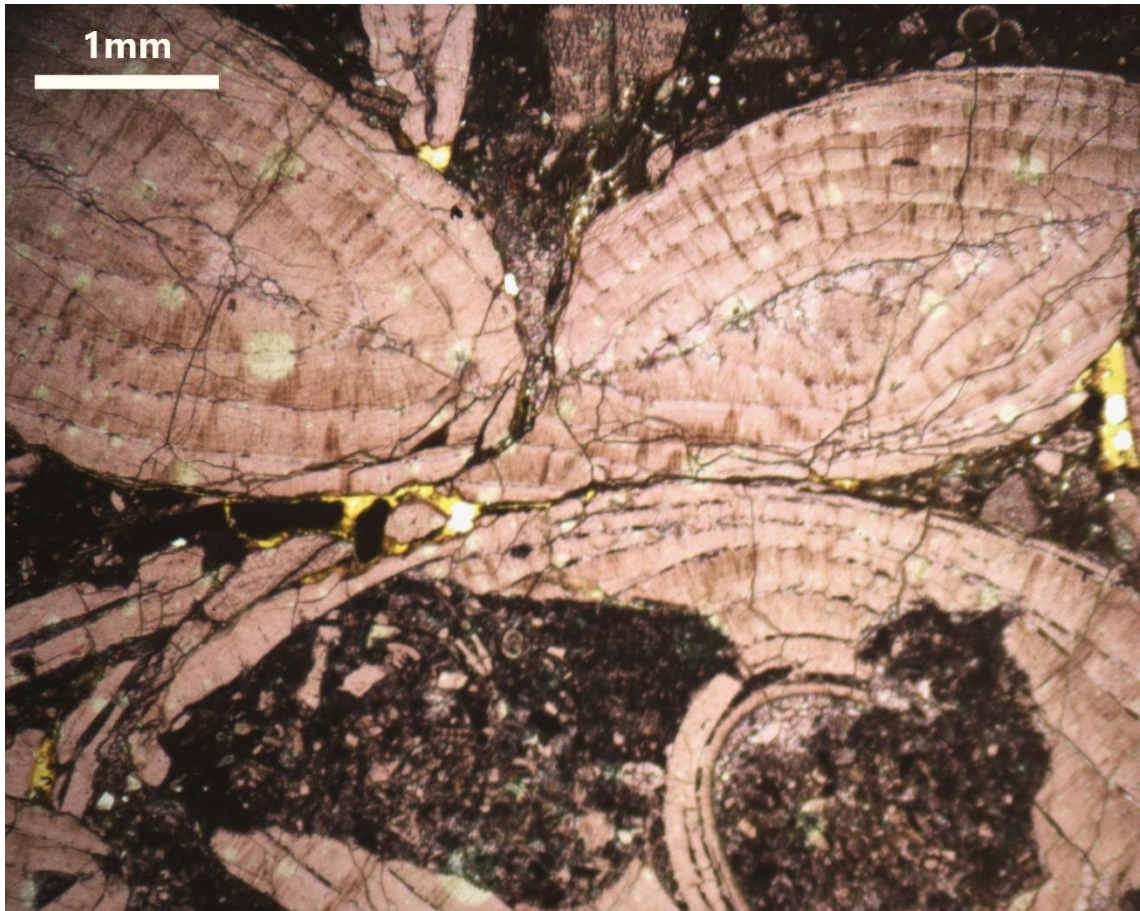
Slika 5-11. Mikrofotografija uzorka SK-3 koji prikazuje biokalkrudit.
