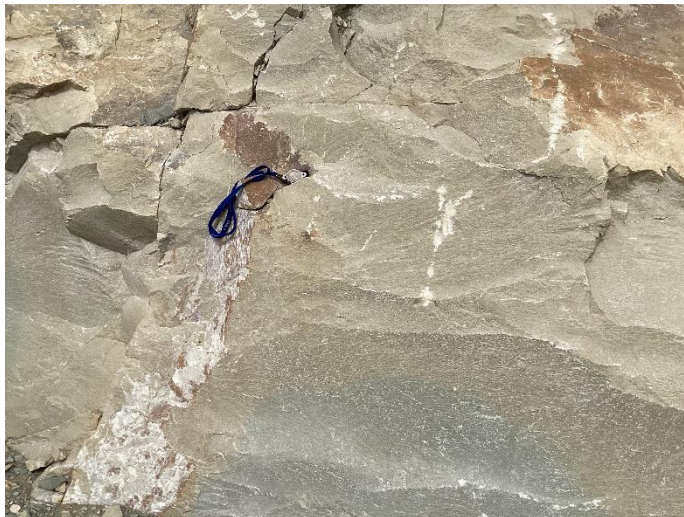
Slika 5-13. Homogeni izgled kalkarenita na terenu.
