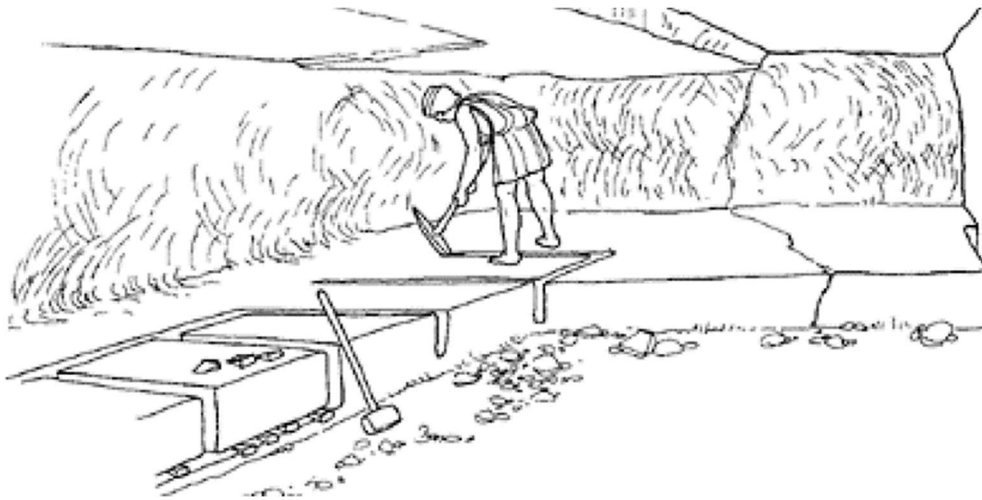
Slika 3-3 Rekonstrukcija starorimskog načina dobivanja mekanog kamena u kamenolomu Grotta Oscura (Adam, 1994)
