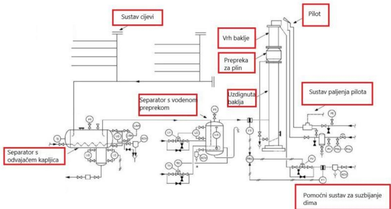
**Slika 3-3.** Shema sustava za spaljivanje plina na kopnu (Park, 2020)
