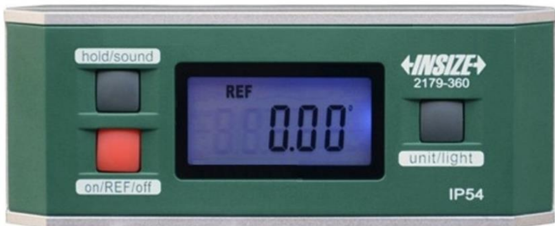
Slika 3-3 – Digitalni mjerač nagiba korišten u ispitivanjima ( insizeus.com )
