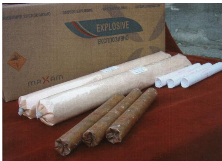
Slika 2-7. Oblici patroniranja praškastih eksploziva (Explo promet, 2020)
