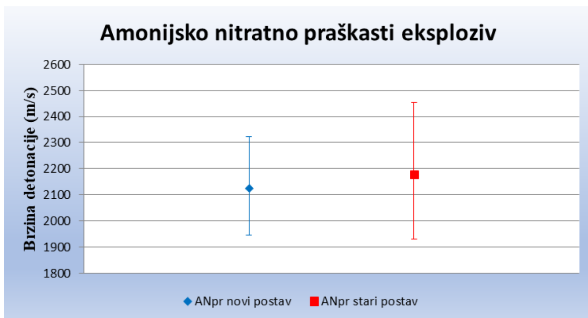
Slika 5-10. Odstupanja od srednje vrijednosti mjerenja brzine detonacije amonijsko nitratnog praškastog eksploziva s oba postava.
