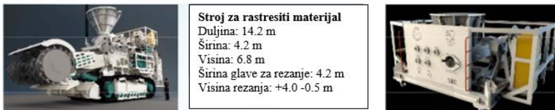
Slika 4-6. Stroj za sukcesivni iskop s rotirajućim reznim bubnjem (Wang, 2013.)
