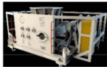
**Slika 4-6.** Stroj za sukcesivni iskop s rotirajućim reznim bubnjem (Wang, 2013.)
