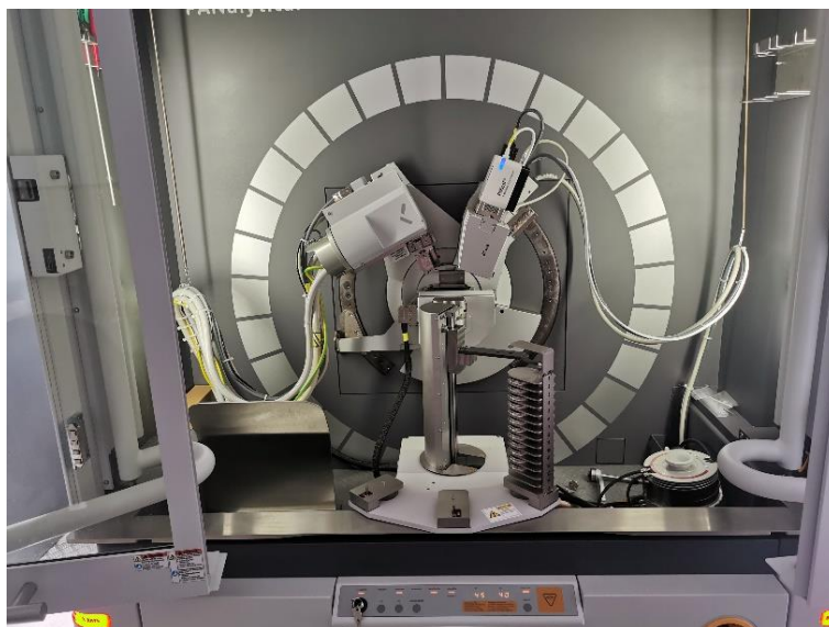
Slika 5-2. Difraktometar Malvern PANalytical Empyrean.
