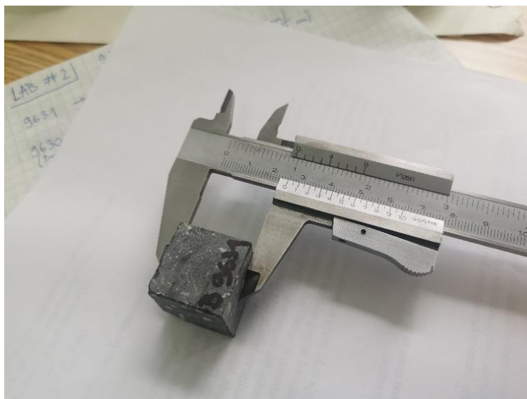
Slika 5-9. Mjerenje stranica ispiljenog uzorka (oznaka 9631 B odgovara XRD analizi pod kojim se uzorak vodi u laboratoriju za rendgensku difrakciju).
