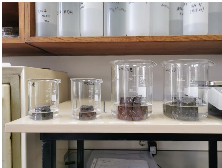
Slika 5-12. Ispitivani uzorci potopljeni u destiliranu vodu do 2/3 volumena kocke.
