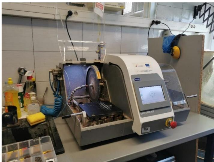
*Slika 5-4. Uređaj za piljenje/dimenzioniranje Kemet Geoform 102.*
