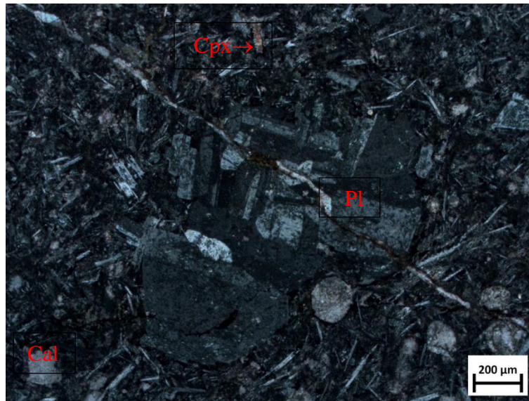
Slika 6-5. Glomeroporfirna struktura uzorka MM5/1. Fenokristali plagioklasa u osnovi izgrađenoj od mikrolita plagioklasa (Pl) i klinopiroksena (Cpx). Slika N+
