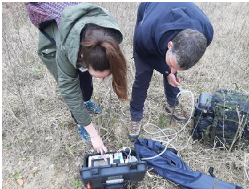
Slika 5-7. Primjer mjerenja koncentracije radona u tlu
