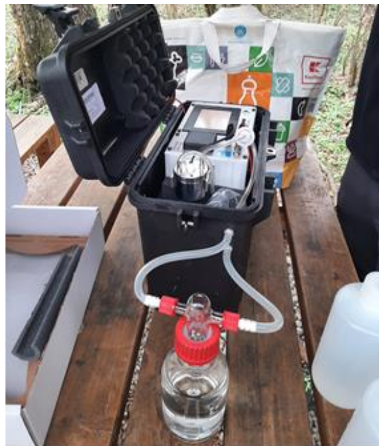
Slika 5-2. Primjer mjerenja koncentracije radona u vodi
