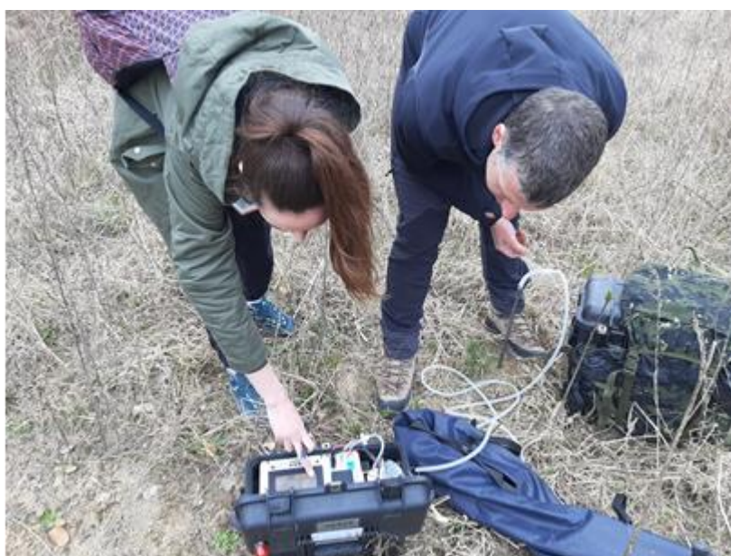
Slika 5-7. Primjer mjerenja koncentracije radona u tlu
