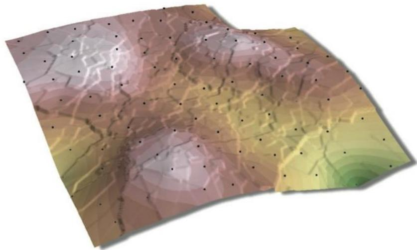
**Slika 3-8.** DMR dobiven *Kriging* interpolacijom (Murayama & Estoque, 2011)
