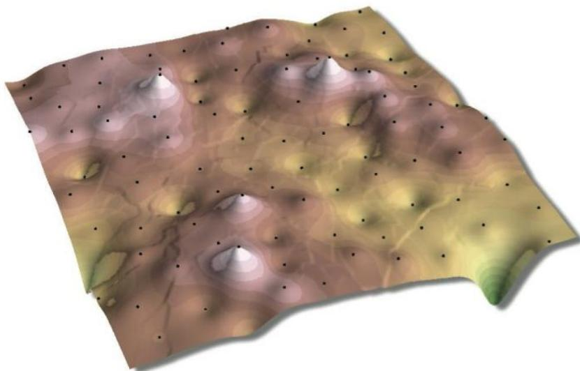
**Slika 3-6.** DMR dobiven IDW interpolacijom (Murayama & Estoque, 2011)
