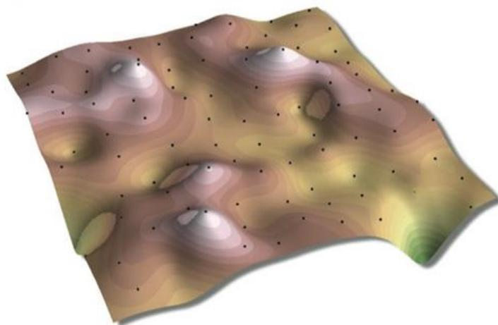
**Slika 3-7.** DMR dobiven *Spline* interpolacijom (Murayama & Estoque, 2011)
