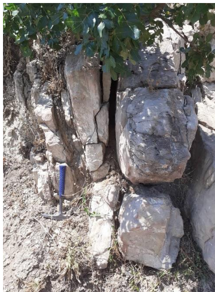
Slika 3-7 Točka 5, Kontakt kalkarenita(lijevo) i breča(desno)
