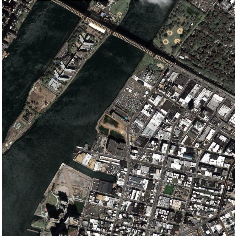
Slika 6-1. Prikaz krovova obojanih u bijelo za svrhu smanjivanja površinskih temperatura u Queens-u, New York (NASA, 2012)
