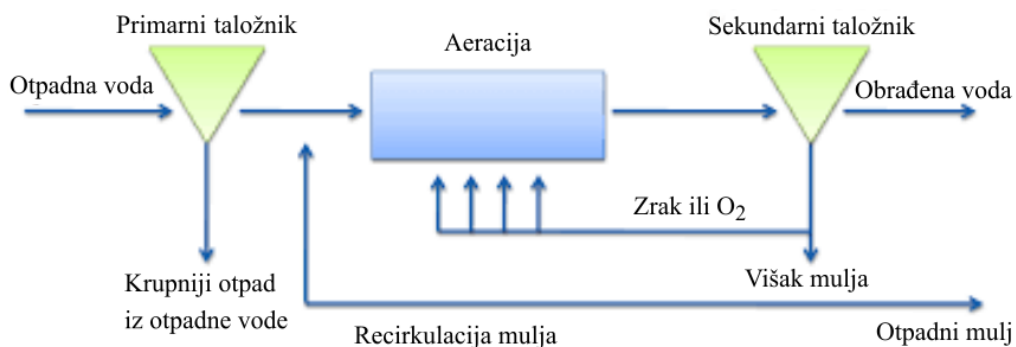
Slika 4.1. Postupak obrade otpadne vode s aktivnim muljem (Vukić, 2015)
