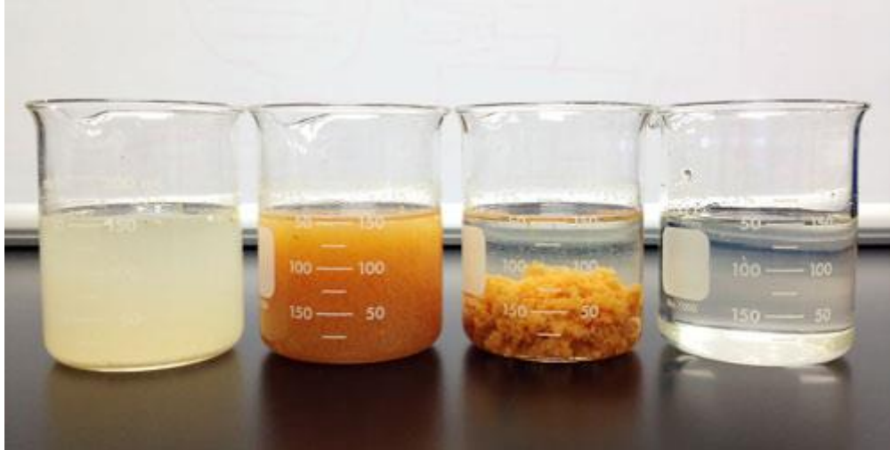
Slika 4.5. Proces koagulacije i flokulacije otpadne vode ( https://aquavmv.hr/flokulanti/ )
