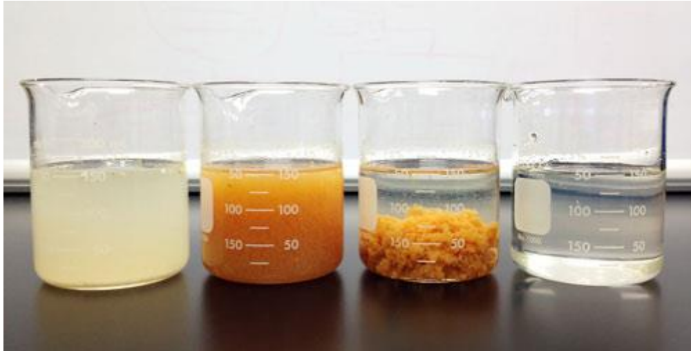
Slika 4.5. Proces koagulacije i flokulacije otpadne vode ( https://aquavmv.hr/flokulanti/ )
