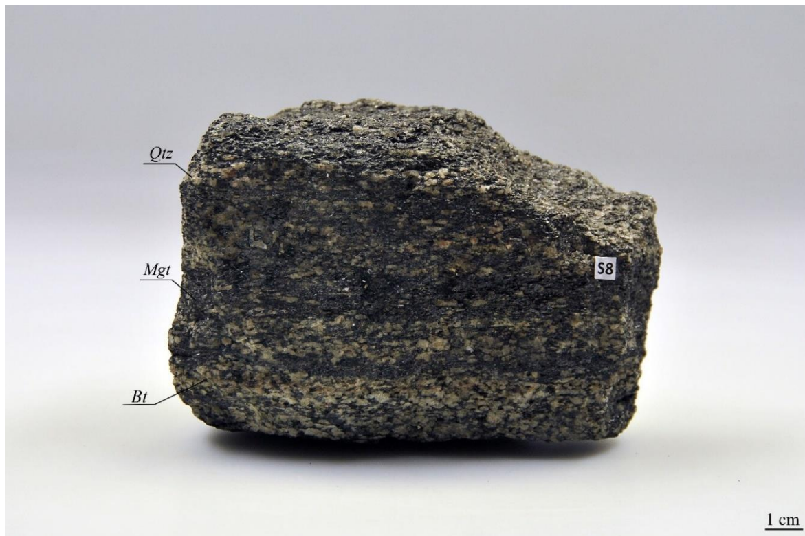
Slika 5-2 h: Željezoviti skarn (S8)
