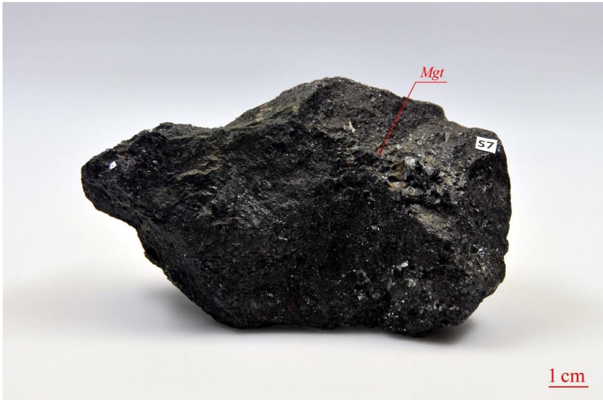
Slika 5-2 g: Željezoviti skarn (S7)
