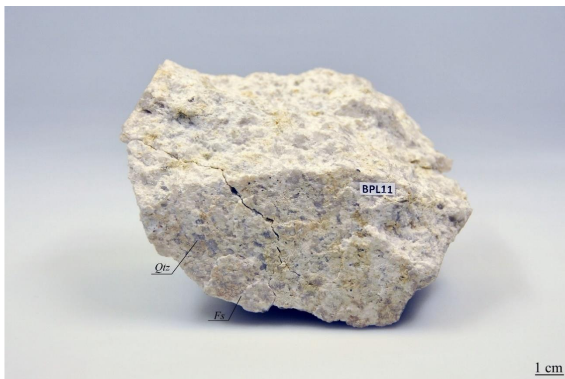
Slika 5-3 j: Alteracije u Cu-porfirnom ležištu (BP11)
