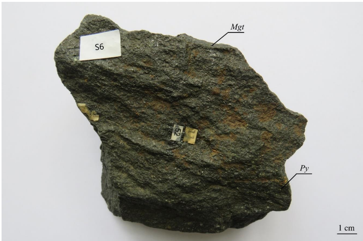
Slika 5-2 f: Željezoviti skarn (S6)
