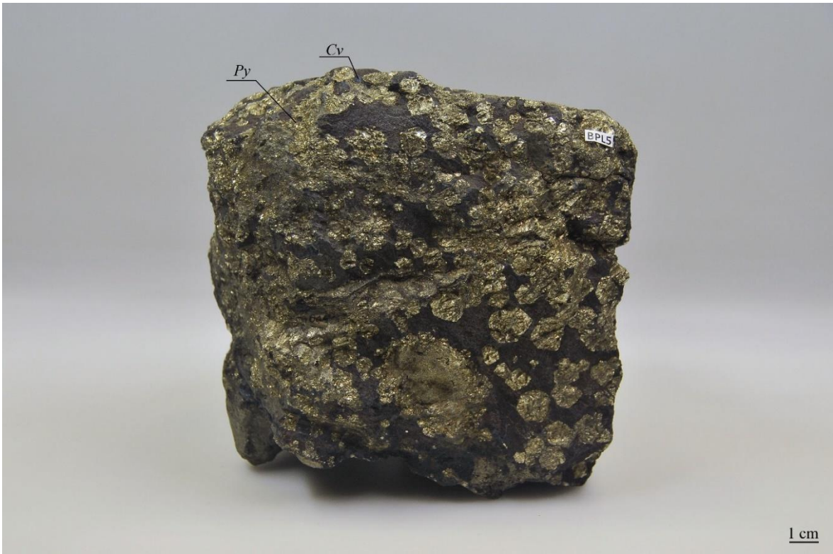
Slika 5-3 d: Cu-porfirna ruda (BPL5)
