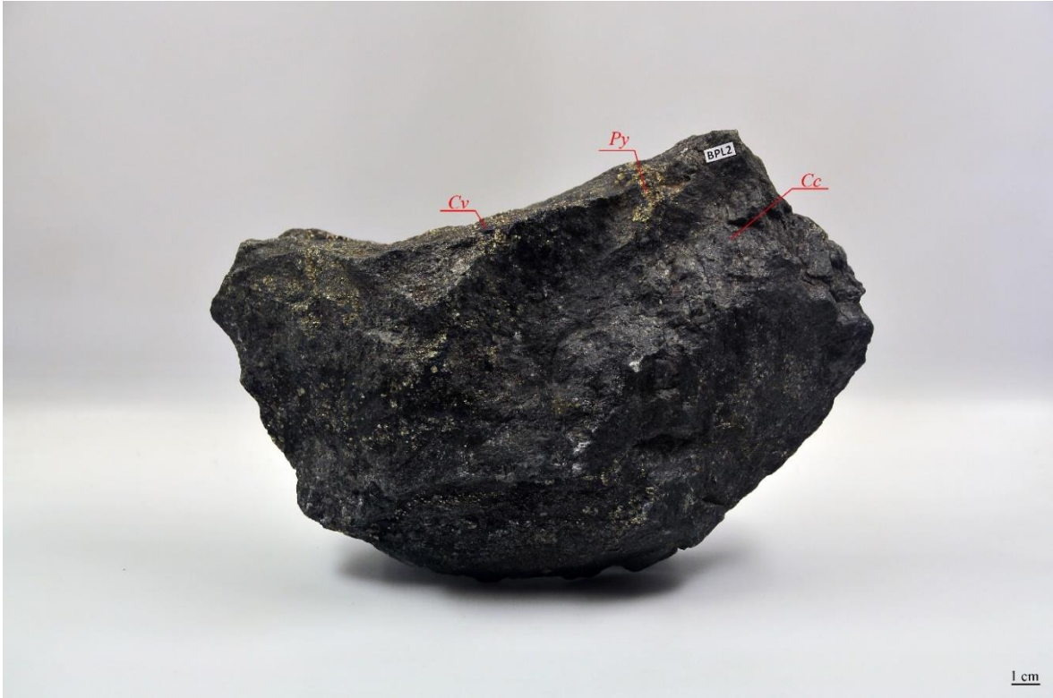
Slika 5-3 b: Cu-porfirna ruda (BPL2)
