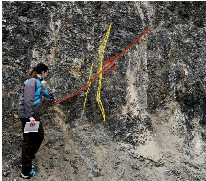
Slika 5.11 Normalni rasjed orijentacije R= 2/37 koji je izmjeren u trijaskim dolomitima. Relativan pomak je definiran temeljem orijentacije vlačnih/tenzijskih pukotina (označeno žutim poligonom) koje nastaju progresivnom rotacijom u zoni smicanja. Točka opažanja se nalazi između Daruvara i Petrovog vrha. Lokacija točke opažanja (Hy-144) se nalazi između Daruvara i Petrovog vrha.
