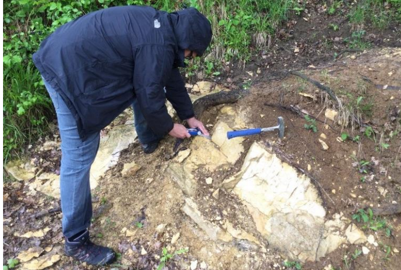
Slika 3.18 Pontski lapori i mjesto gdje je izmjerena slojevitost orijentacije S0 125/25. Lokacija točke opažanja (D-12) se nalazi u blizini Markovca JZ od Petrovog vrha.
