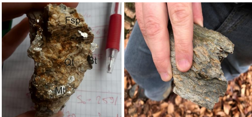
Slika 3.10 Pegmatiti unutar granitoida na lijevoj slici s vidljivim tinjcima (muskovit, biotit- Mt, Bt), feldspati (Fsp), kvarc (Q) i na desnoj slici fragment škriljavca bogat granatima. Lokacija točke opažanja pegmatita (636) se nalazi SI od mjesta D.Borki. Lokacija točke opažanja škriljavaca (Hy-22-9) se nalazi JI od Barice.
