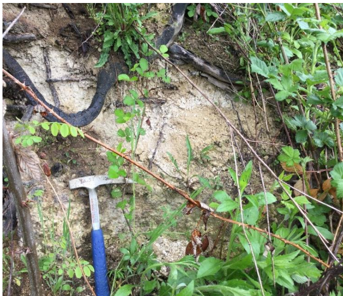
Slika 3.17 Prijelaz iz litotamnijskih vapnenaca (donji dio čekića) u sarmatske lapore (iznad čekića). Lokacija točke opažanja (D-13) se nalazi u blizini Markovca JZ od Perovog vrha.
