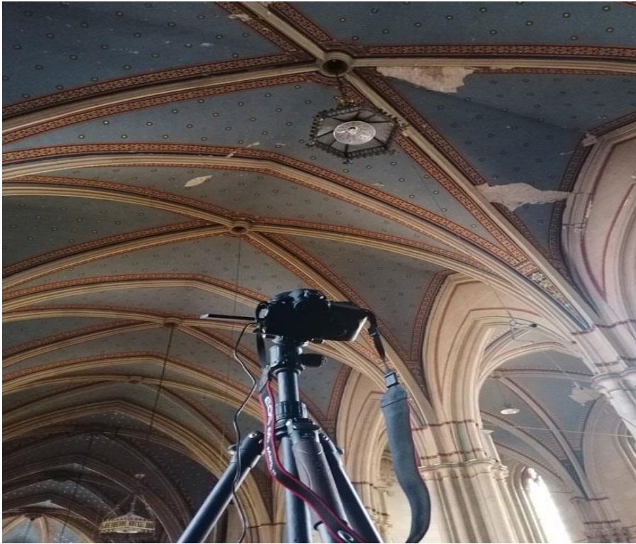
Slika 5-2 - Prikaz snimanja terestičkom fotogrametrijom ( https://geofocus.hr )
