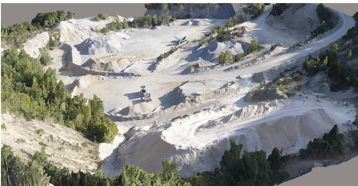
Slika 5-7 - Rezultat rekonstrukcije prikazan u ContextCapture Viewer-u
