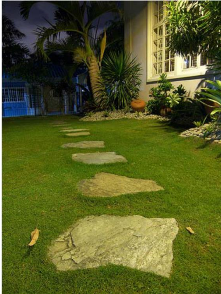
Slika 5-5. Krupna jalovina korištena kao podna obloga (Papantonopoulos i sur., 2007)
