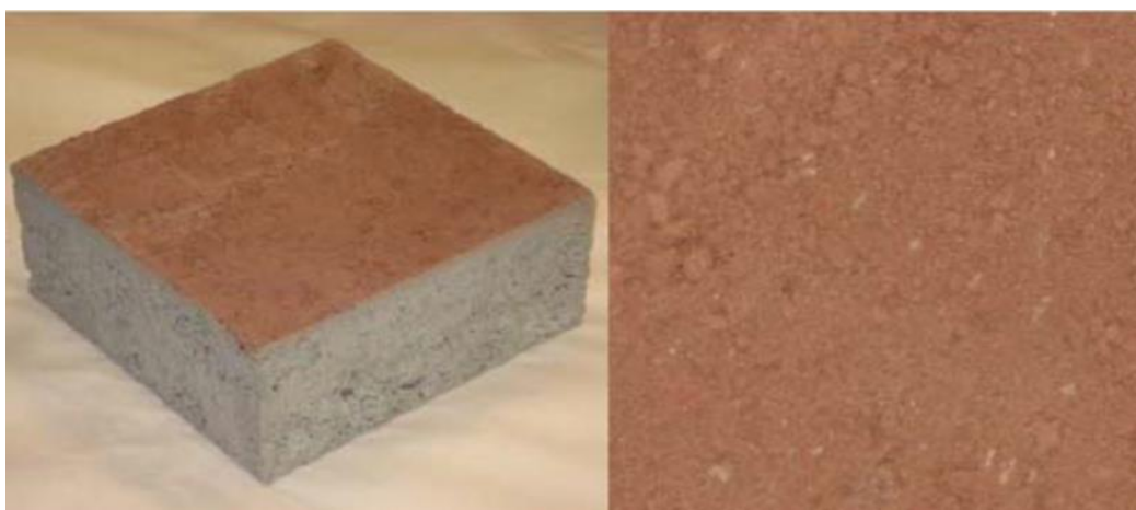
Slika 5-3. Kameni mulj kao sastojak u proizvodnji pločica (Papantonopoulos i sur., 2007)
