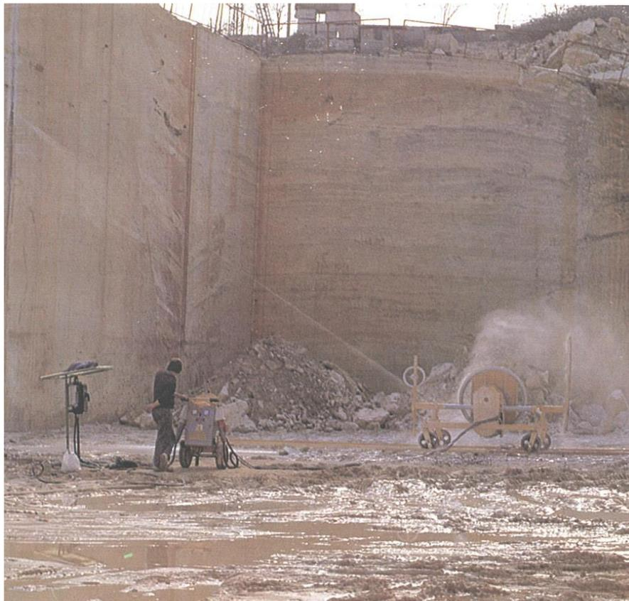
**Slika 2-5.** Dijamantna žična pila (Dunda i Kujundžić, 2003)
