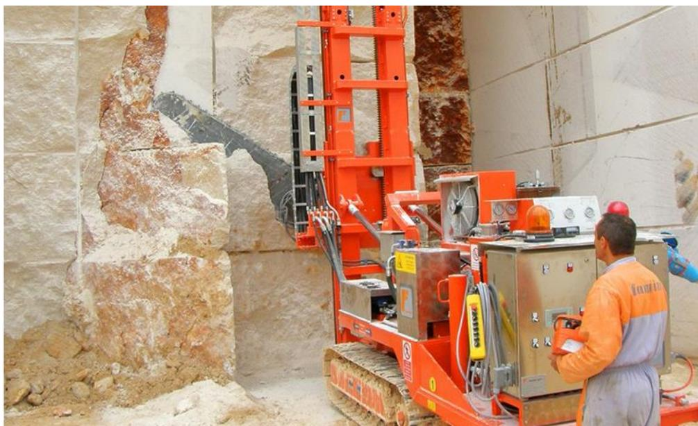
**Slika 2-4.** Lančana sjekačica (Mineral i gradnja, 2018)
