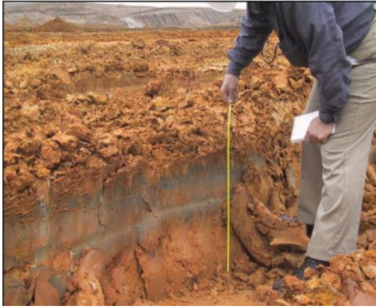
Slika 5-2. Dubina kolotruga pri otporu kotrljanja od 30% (Thompson, 2021)
