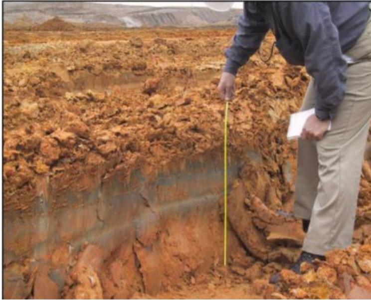
**Slika 5-2.** Dubina kolotruga pri otporu kotrljanja od 30% (Thompson, 2021)
