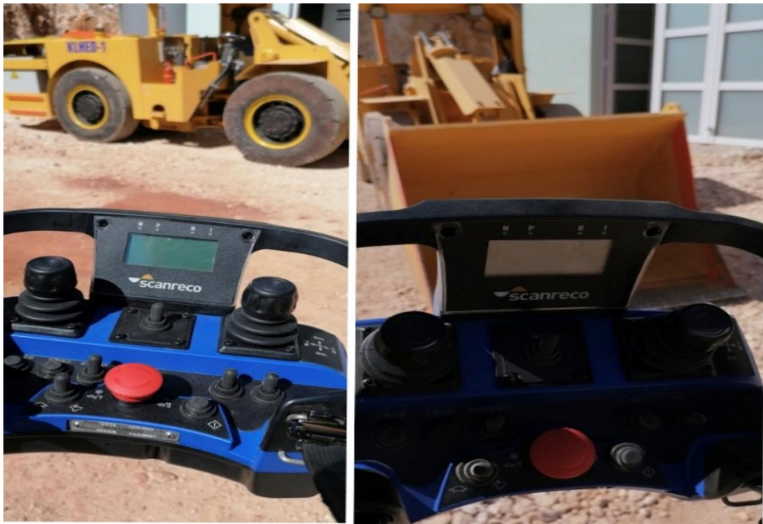
Slika 5-3. Daljinske komande jamskog utovarivača KHLED-1
