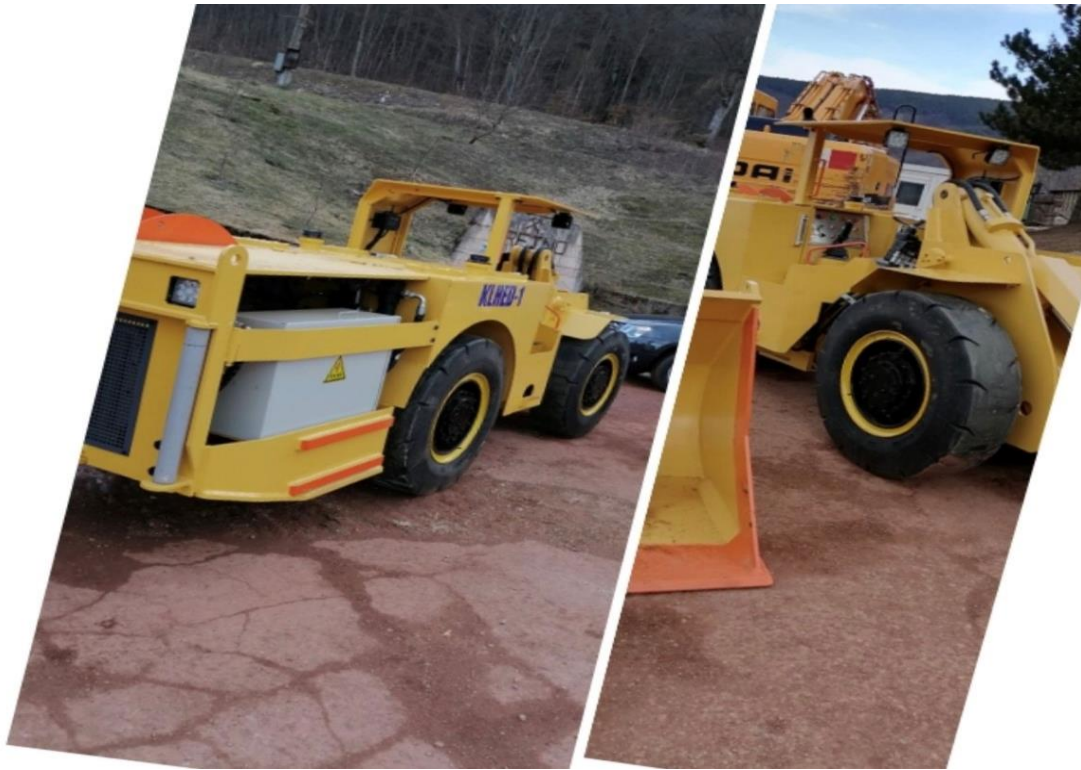
Slika 5-2. Jamski utovarivač KHLED-1
