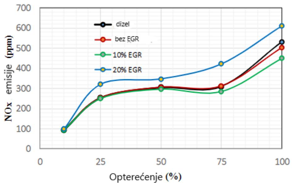
Slika 4-2. Emisija NO<sub>x</sub> u ppm u odnosu na opterećenje motora u postocima za dizel, dodavanje vodika bez EGR-a i s 10% i 20% EGR-a (Hoang i Pham, 2020)
