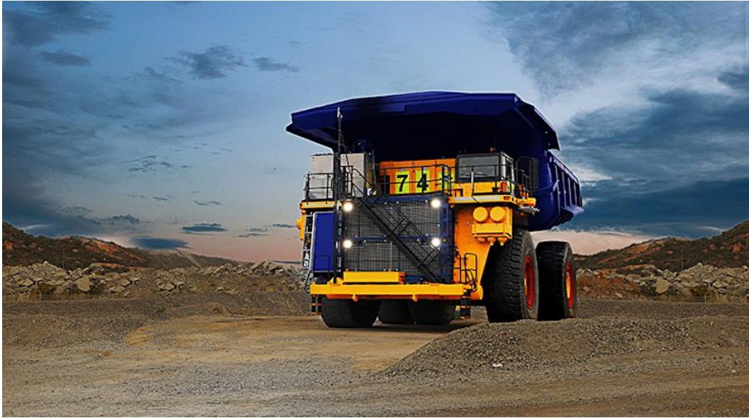
Slika 5-2. Najveći hibridno pogonjeni kamion vodikom i električnim baterijama (Mining.com, 2022.)
