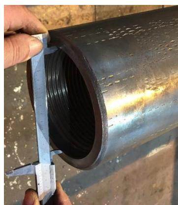
**Slika 4-11.** Mjerenje izlaznog promjera ženskog dijela spojnice (CROSCO, 2019)
