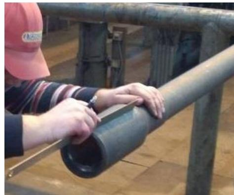
**Slika 4-6.** Provjera napuhnutošti i bubrenja spojnice bušaće šipke (CROSCO, 2019)
