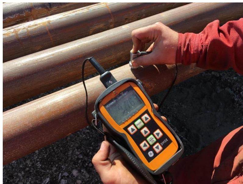
**Slika 3-13.** Mjerenje debljine stijenke ručnom ultrazvučnom metodom (CROSCO, 2019)
