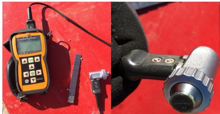
**Slika 3-10.** Ultrazvučni mjerač (CROSCO, 2019)
