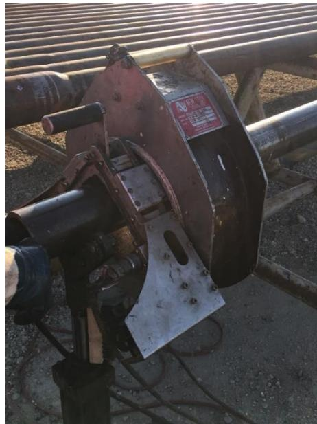
**Slika 3-18.** Pregled tijela bušaće šipke elektromagnetskom metodom (CROSCO, 2019)
