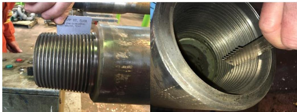
**Slika 4-5.** Provjera istrošenosti navojnih spojeva pomoću kalibra (CROSCO, 2019)
