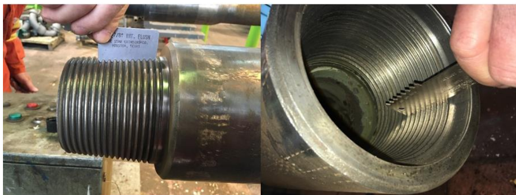
Slika 4-5. Provjera istrošenosti navojnih spojeva pomoću kalibra (CROSCO, 2019)
