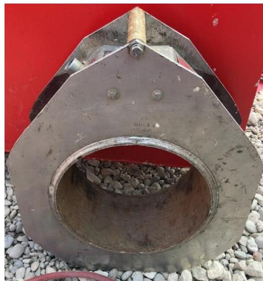
**Slika 3-16.** Magnetizirajuća istosmjerna zavojnica (CROSCO, 2019)
