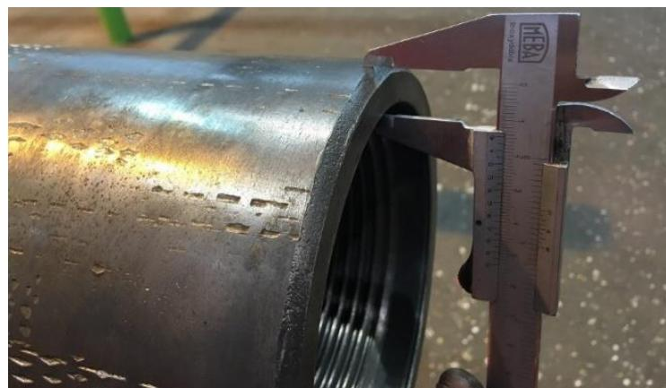
**Slika 4-13.** Mjerenje širine ramena ženske spojnice (CROSCO, 2019)
