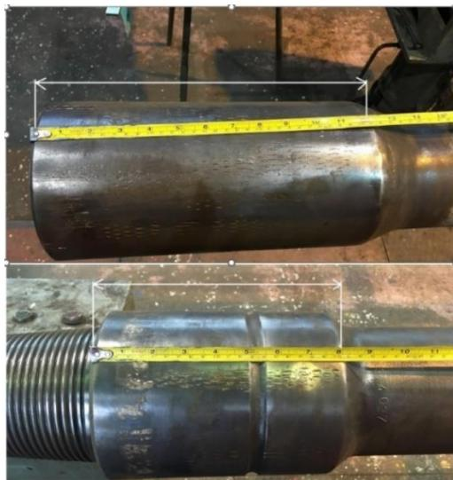
**Slika 4-16.** Mjerenje dijela za obuhvat kliještima na ženskom i muškom dijelu spojnica (CROSCO, 2019)
