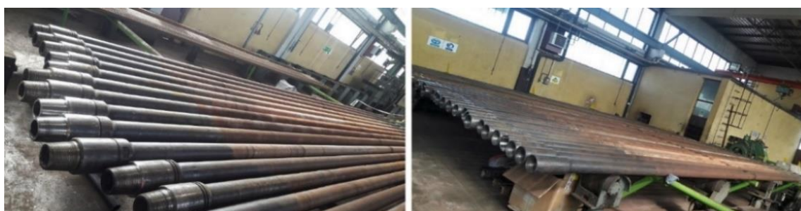
Slika 3-4. Cijevi odgovarajuće poslagane za provođenje vizualne kontrole (CROSCO, 2019)
