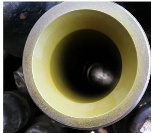
**Slika 3-6.** Prikaz provjere unutarnje zaštitne plastične prevlake (CROSCO, 2019)
