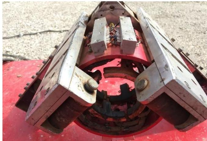
**Slika 3-17.** Ispitna glava sa senzorima (CROSCO, 2019)
