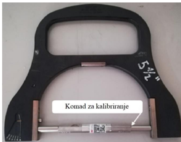
Slika 3-7. „Go-no go“ mjerilo i komad za kalibriranje (CROSCO, 2019)
