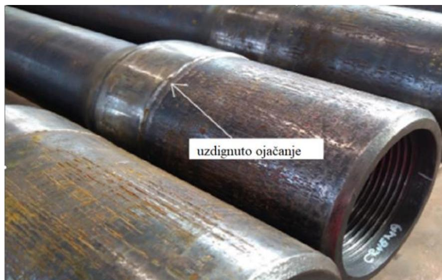
Slika 4-18. Uzdignuće ojačanja (CROSCO, 2019)
