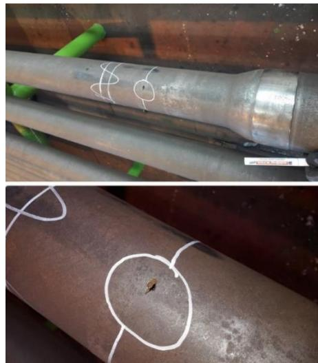
**Slika 3-5.** Označavanje vizualno otkrivenih oštećenja (CROSCO, 2019)
