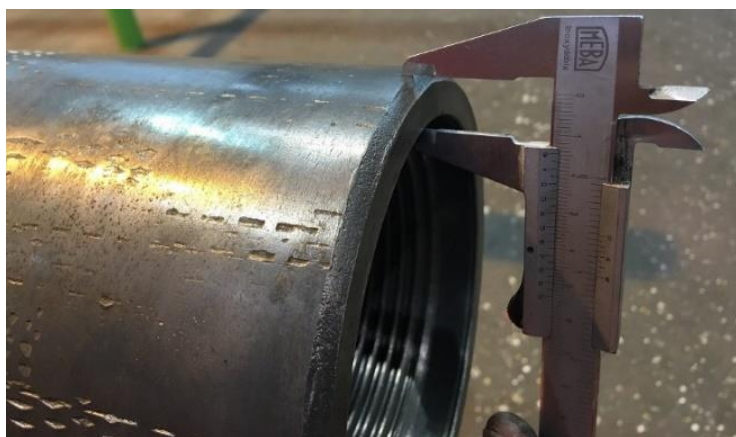
Slika 4-13. Mjerenje širine ramena ženske spojnice (CROSCO, 2019)
