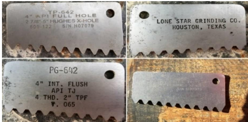
Slika 4-2. Kalibri za navoje korišteni kod vizualnog pregleda spojnica bušaćih šipki (CROSCO, 2019)
