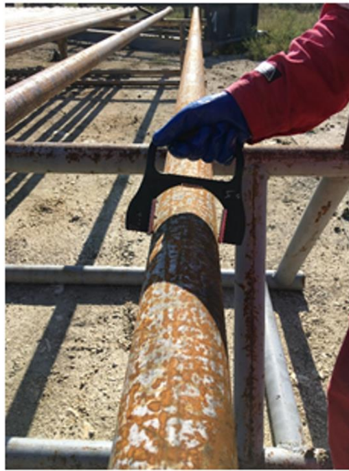
Slika 3-8. Mjerenje vanjskog promjera tijela cijevi „Go - no go“ mjerilom (CROSCO, 2019)
