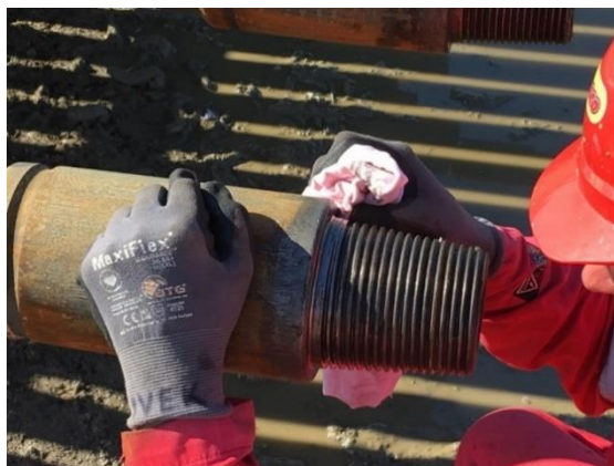
Slika 4-3. Traženje oštećenja i nedostataka kod vizualnog pregleda spojnica bušaćih šipki (CROSCO, 2019)
