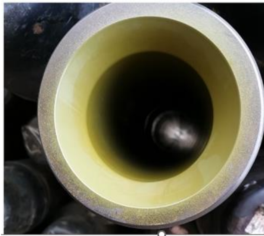
Slika 3-6. Prikaz provjere unutarnje zaštitne plastčne prevlake (CROSCO, 2019)
