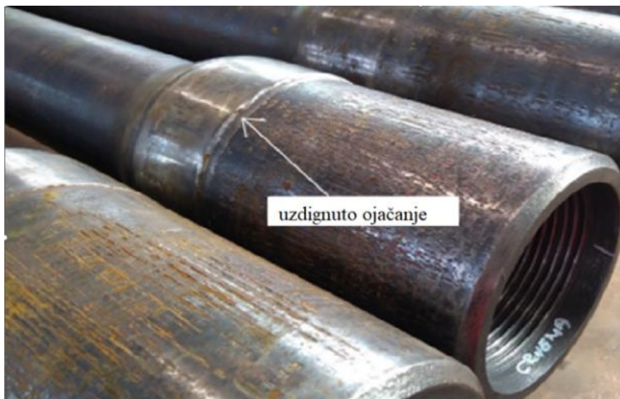
Slika 4-18. Uzdignuće ojačanja (CROSCO, 2019)
