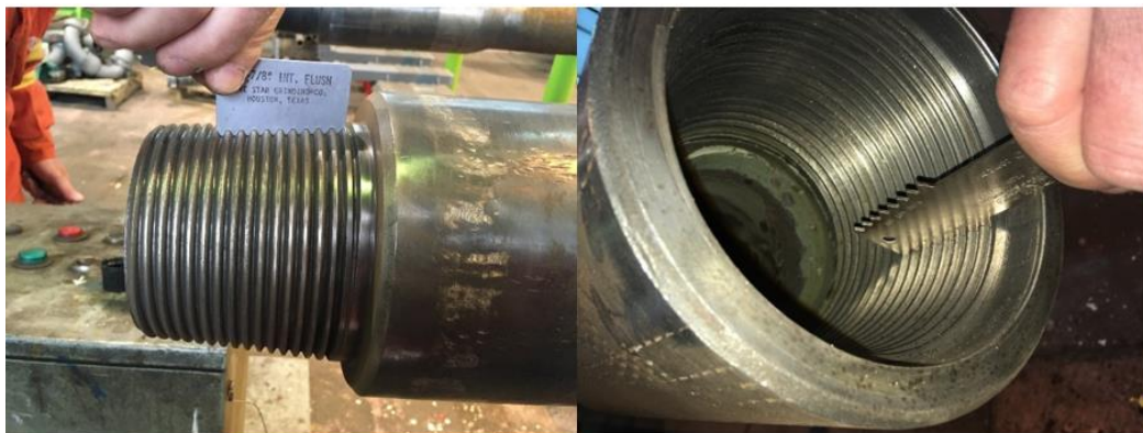
Slika 4-5. Provjera istrošenosti navojnih spojeva pomoću kalibra (CROSCO, 2019)
