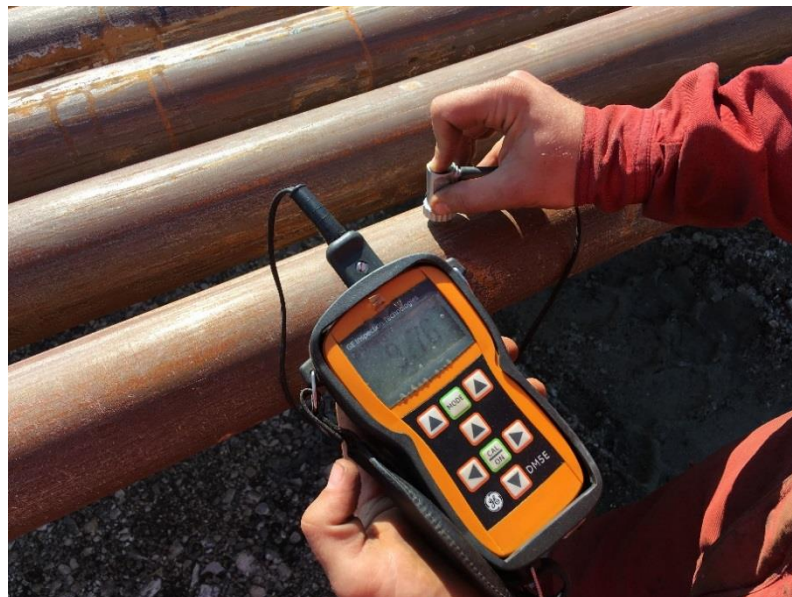
Slika 3-13. Mjerenje debljine stijenke ručnom ultrazvučnom metodom (CROSCO, 2019)
