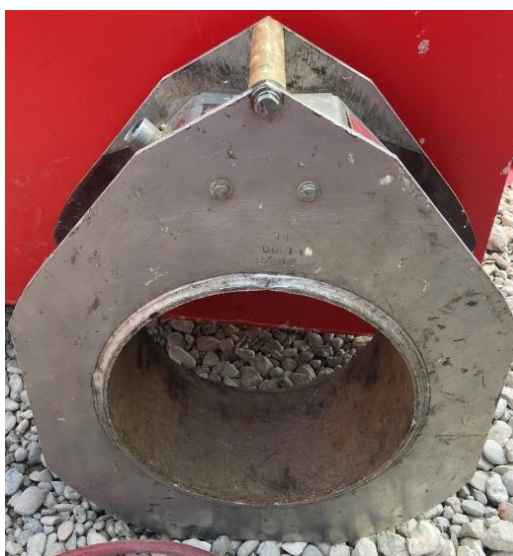
Slika 3-16. Magnetizirajuća istosmjerna zavojnica (CROSCO, 2019)
