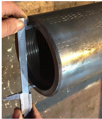
Slika 4-11. Mjerenje izlaznog promjera ženskog dijela spojnice (CROSCO, 2019)
