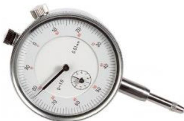
**Slika 3-3.** Komparator za mjerjenje dubine oštećenja (<https://www.alatimilic.hr/>, 2022)
