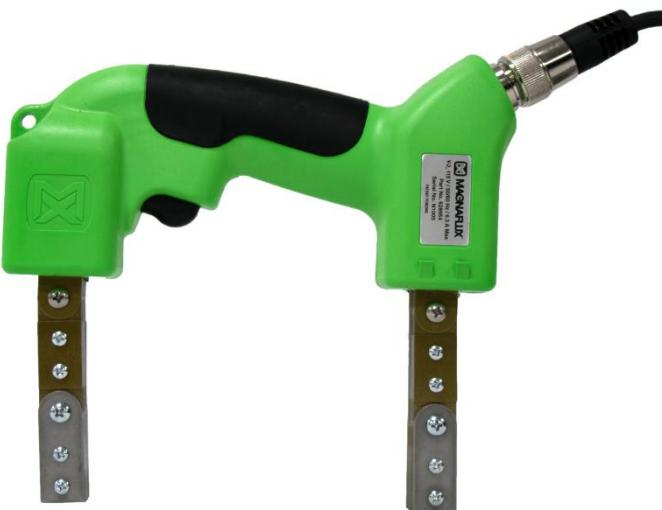
**Slika 3-13.** Električni napajana magnetska potkova (<https://irss.ca/>, 2022)
