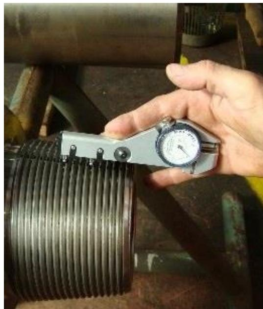
**Slika 4-4.** Provjera produljenja muškog navoja mjerilom uspona (Crosco, 2008)
