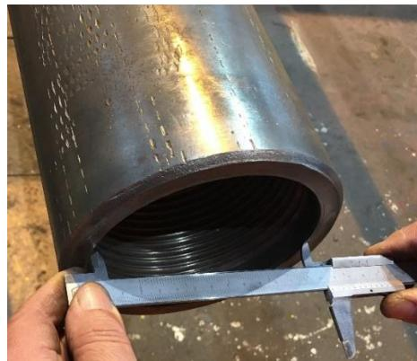
**Slika 4-2.** Provjera unutarnjeg promjera ženske spojnica (Crosco, 2008)
