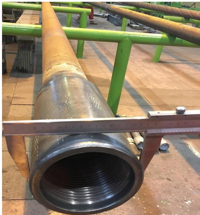
**Slika 4-3.** Provjera vanjskog promjera ženske spojnice (Crosco, 2008)
