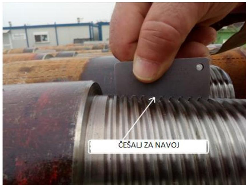
**Slika 4-6.** Provjera istrošenosti navoja češljem za navoj (Crosco, 2008)
