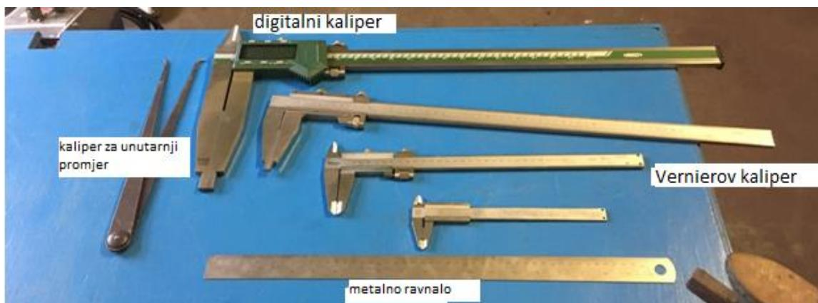
Slika 4-1. Oprema za dimenzionalni pregled tubinga i spojnica (Crosco, 2008)
