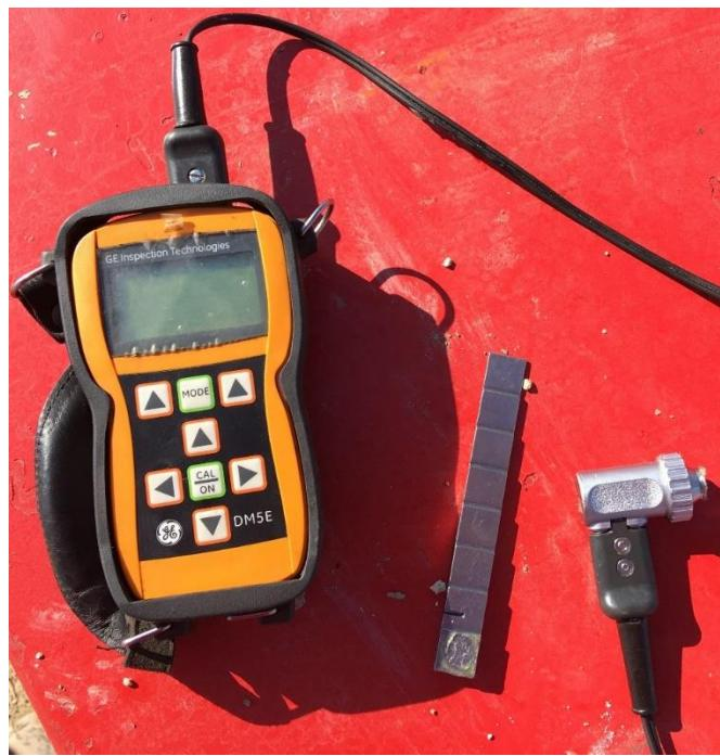
**Slika 3-7.** Ultrazvučni mjerač debljine stjenke (Crosco, 2008)
