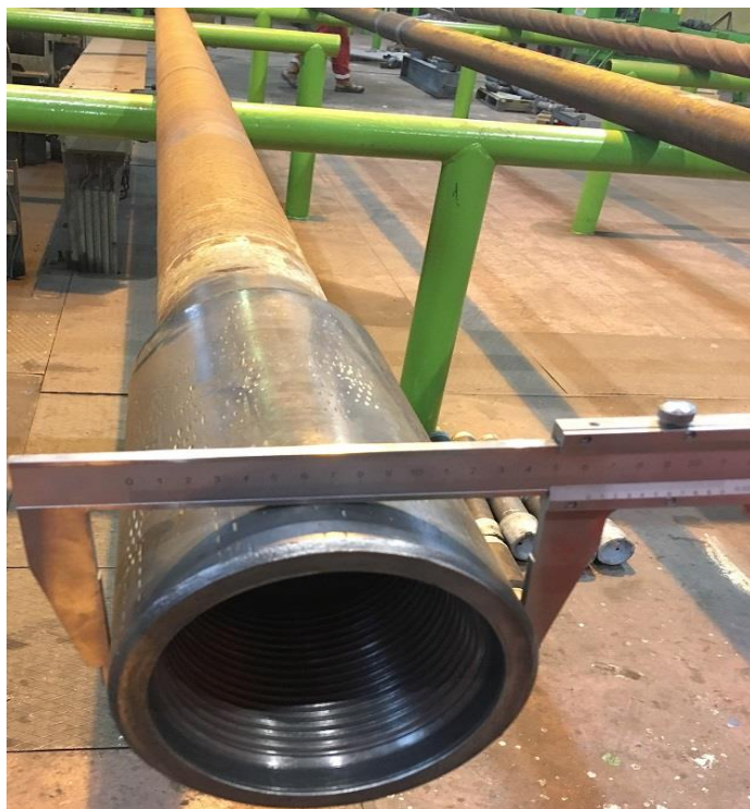
Slika 4-3. Provjera vanjskog promjera ženske spojnice (Crosco, 2008)
