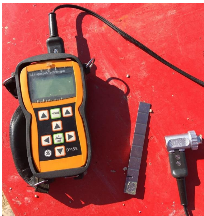
Slika 3-7. Ultrazvučni mjerac debljine stjenke (Crosco, 2008)
