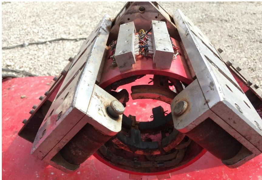
Slika 3-11. Ispitna glava s defektoskopskim papučama (Crosco, 2008)
