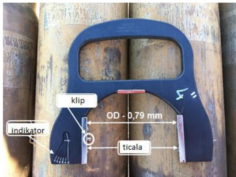
Slika 3-5. Mjerilo za vanjski promjer 101,6 mm (Crosco, 2008)
