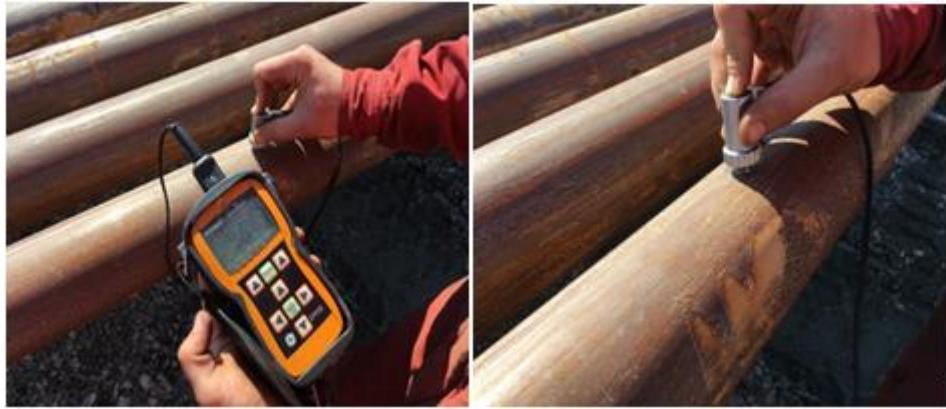
**Slika 3-9.** Postupak mjerena debljine stjenke ultrazvučnim mjeračem (Cresco, 2008)
