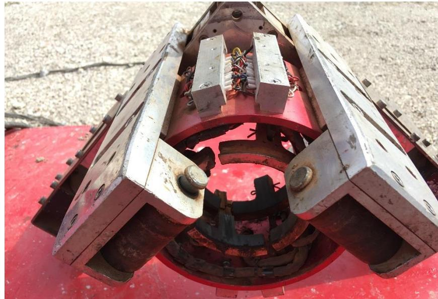
Slika 3-11. Ispitna glava s defektoskopskim papučama (Crosco, 2008)
