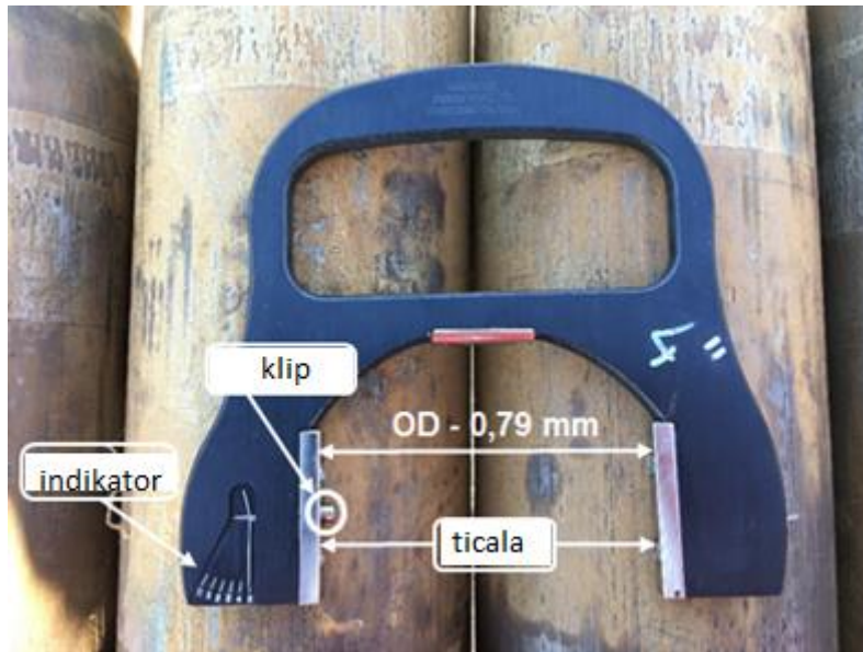
Slika 3-5. Mjerilo za vanjski promjer 101,6 mm (Crosco, 2008)
