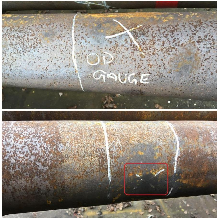
Slika 3-6. Označavanje dijela maksimalnog odstupanja vanjskog promjera (Crosco, 2008)
