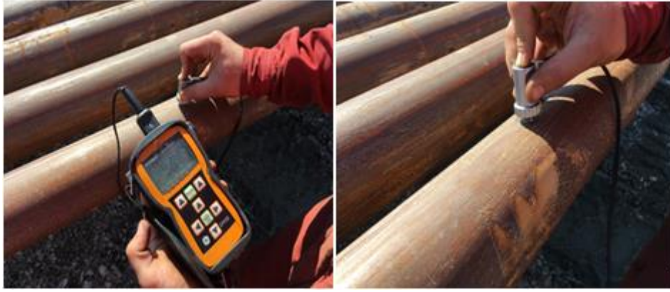
Slika 3-9. Postupak mjerenja debljine stijenke ultrazvučnim mjeračem (Crosco, 2008)
