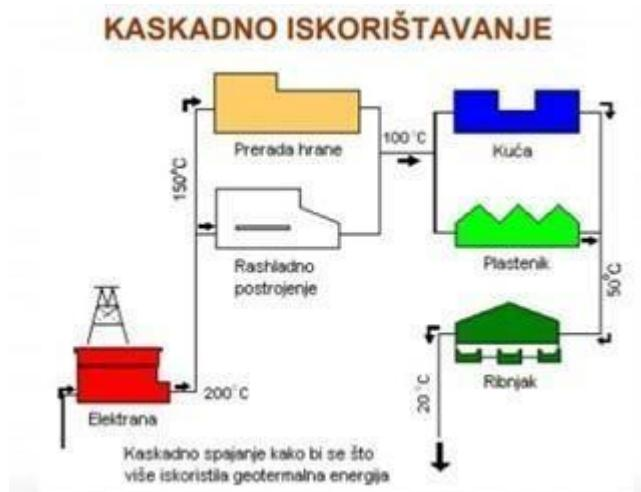
**Slika 2-2.** Shematski prikaz kaskadnog korištenja geotermalne energije (Institut Hrvoje Požar, 2010)
