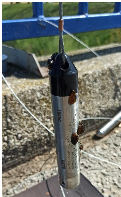
Slika 3.6 Automatski mjerač tvrtke HOBO (u simbiozi s jezerskim živim svijetom nakon određenog vremena provedenog u vodi)
