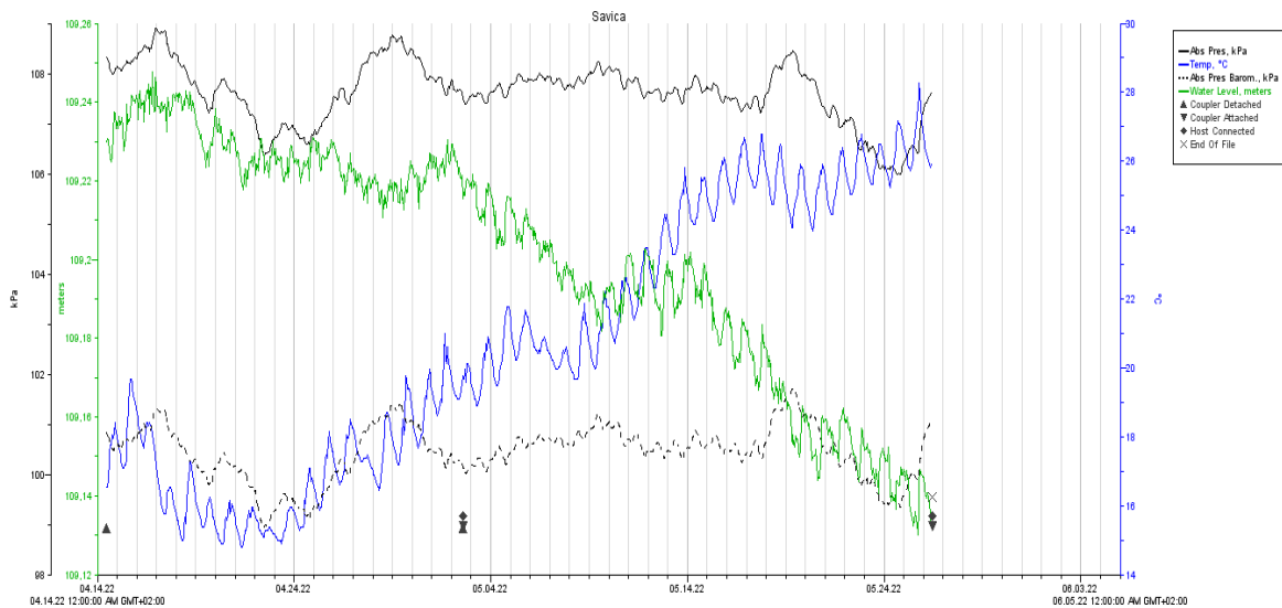
Slika 4.2 Grafički prikaz rezultata mjerenja na Savici, zelena krivulja predstavlja razinu vode (m), plava krivulja temperaturu (°C), a crne krivulje predstavljaju tlakove (ukupni puna linija, atmosferski crtkana)
