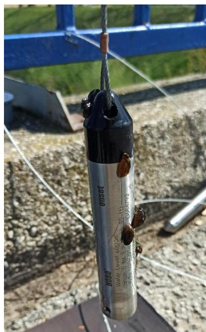
*Slika 3.6 Automatski mjerač tvrtke HOBO (u simbiozi s jezerskim živim svjetom nakon određenog vremena provedenog u vodi)*
