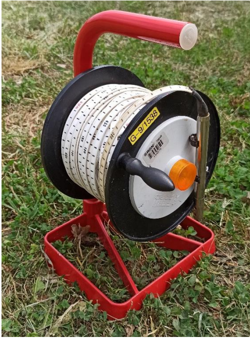
Slika 3.8 Lijevo: ručni mjerač; desno: mjerenje razine podzemne vode u piezometru ručnim mjeračem
