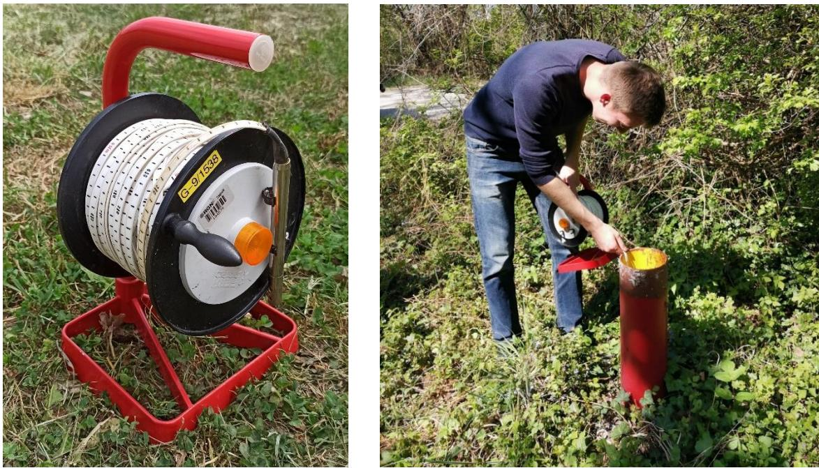
*Slika 3.8 Lijevo: ručni mjerač; desno: mjerjenje razine podzemne vode u piezometru ručnim mjeračem*
