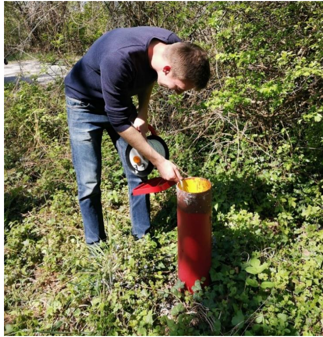
Slika 3.8 Lijevo: ručni mjerač; desno: mjerenje razine podzemne vode u piezometru ručnim mjeračem
