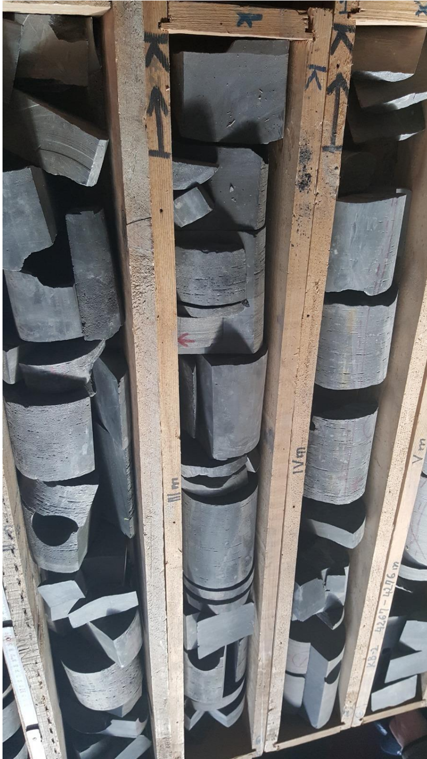
Slika 2-7. Slabopropusni pješčenjak (engl. tight-sand , finozrnati muljnjak) male poroznosti iz RH
