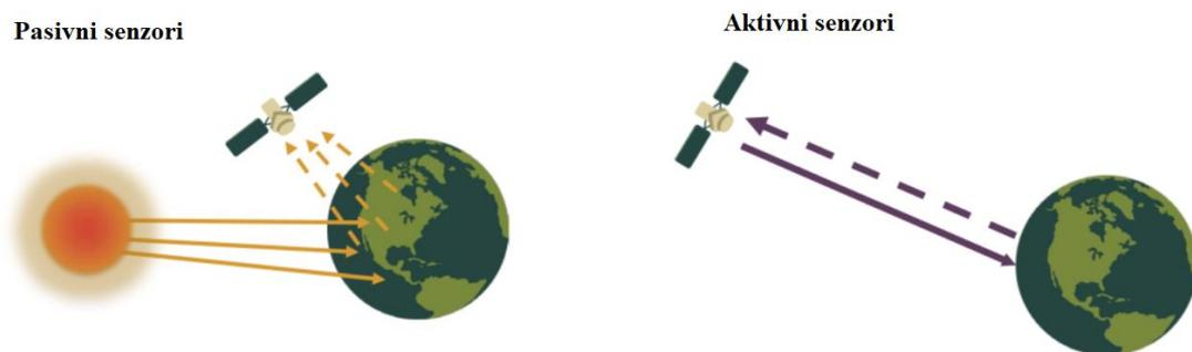
**Slika 3-3** Pasivni i aktivni senzori (Earthdata, 2022)
