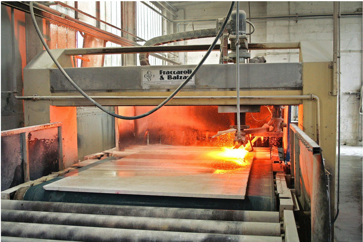
Slika 7-3. Postupak paljenja kamene ploče u postrojenju tvrtke „KAMEN“ d.d. Pazin (KAMEN Pazin, 2022)
