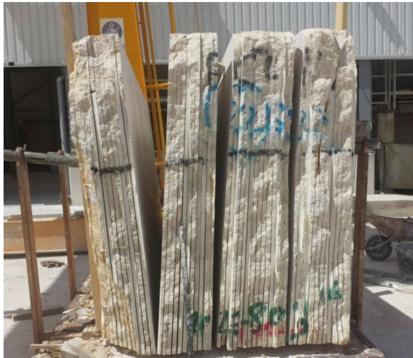
Slika 5-1. Komercijalni blok ispiljen na neobrađene kamene ploče (Pulycort, 2022)
