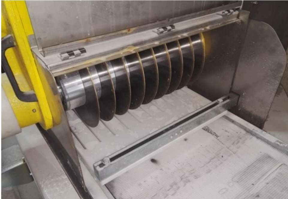
Slika 4-3. Jednoetažni stroj s više diskova (Stonecontact, 2022)
