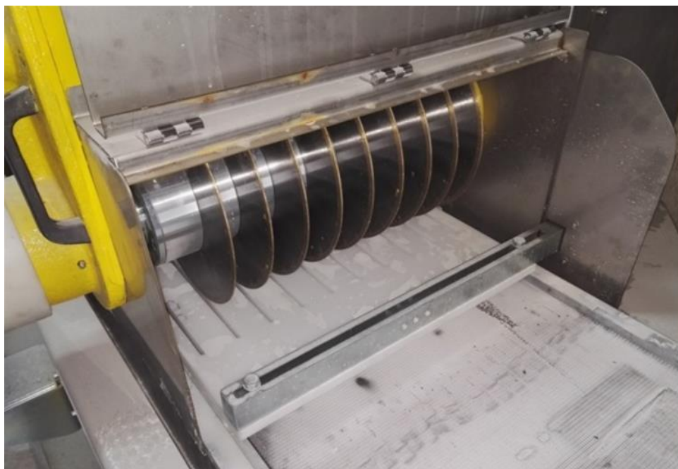
Slika 4-3. Jednoetažni stroj s više diskova (Stonecontact, 2022)
