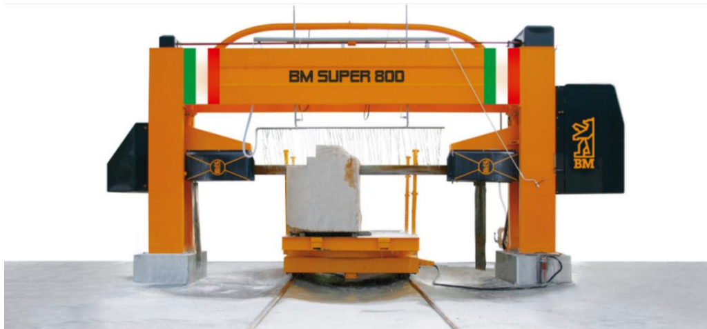
Slika 4-2. Monolama proizvođača „BM Officine SRL“ (BM Officine, 2022)
